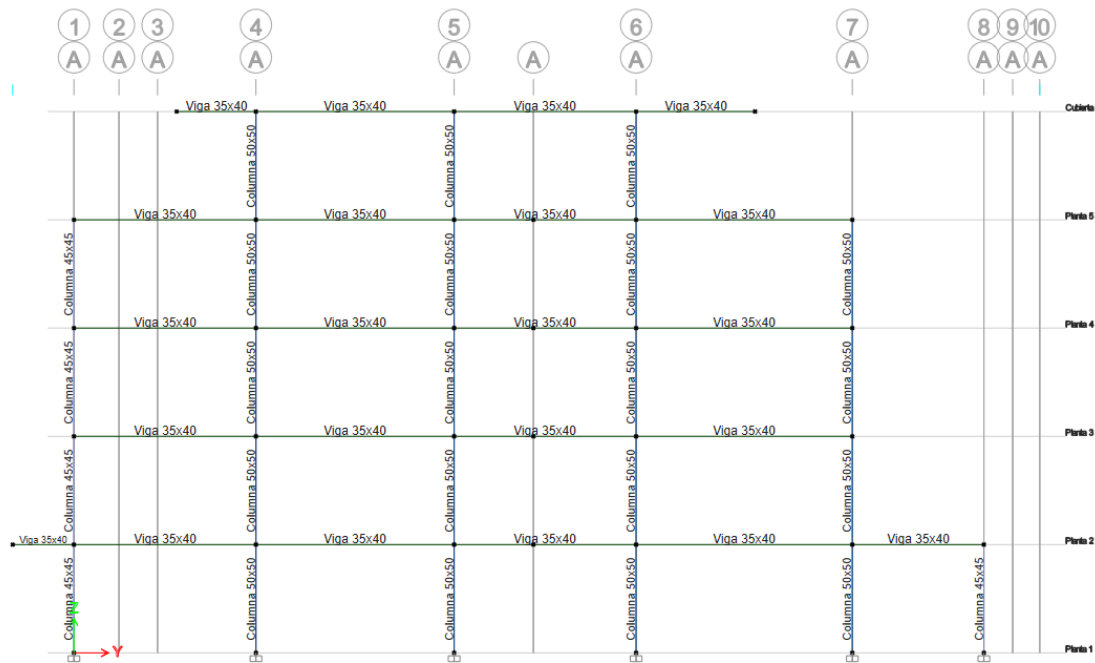
Ilustración 11: Vista en Elevación (secciones)
