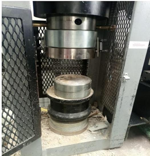
**Figura 2.11:** Máquina preparada para colocar la muestra
