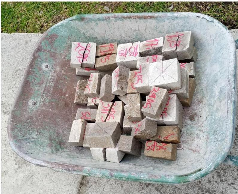
**Figura 2.18:** Rotura de las muestras usando las puntas cónicas
