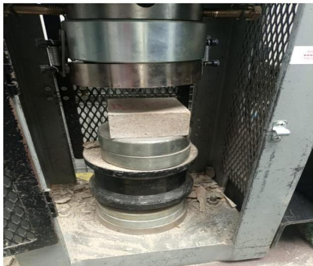
**Figura 2.12:** Colocación de la muestra para ser sometida a la rotura
