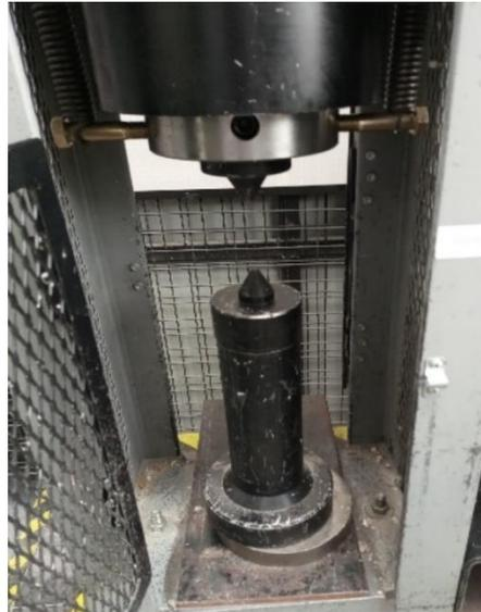
**Figura 2.15:** Máquina preparada con las puntas cónicas
