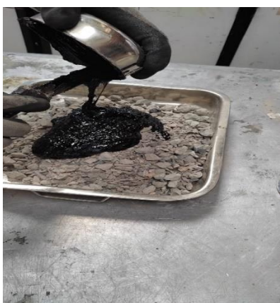
Ilustración 3.50. Asfalto mezclado en caliente con el polímero. Fuente: Elaboración propia.
