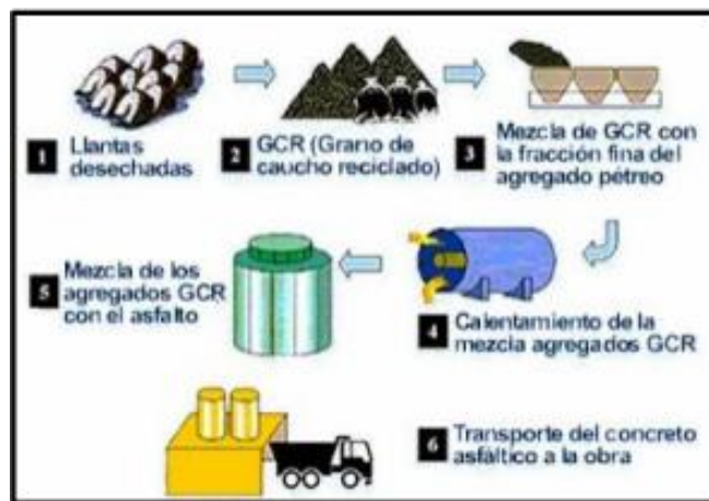
Ilustración 2.2 Incorporación por vía seca. (Ayala & Heredia, 2019)
