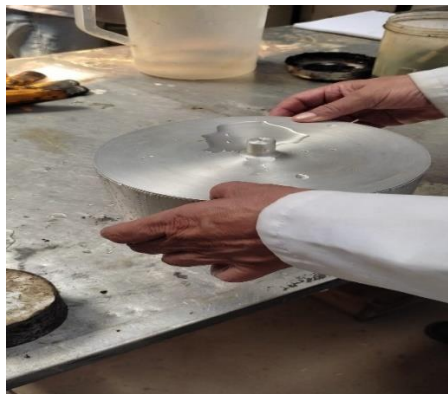
Ilustración 3.6. Uso de picnómetro en el ensayo de gravedad específica.
