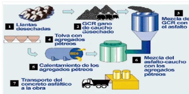
Ilustración 2.3. Incorporación por vía húmeda. (Ramirez, Ladino, & Rosas, 2014) .
