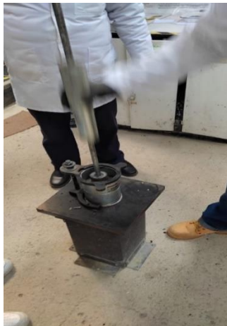
Ilustración 3.14. Martillo de compactación. Fuente: Elaboración propia.
