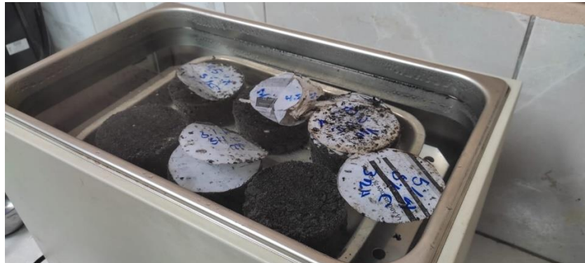
Ilustración 3.17. Equipo de baño María. Fuente: Elaboración propia.
