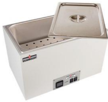
Ilustración 2.8. Horno para baño María. (fabiequipos S.A.S., 2022)
