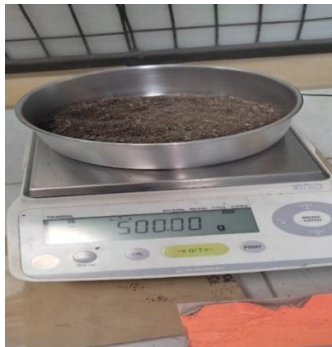
Ilustración 3.3. Masado de las muestras de material para ensayo de gravedad específica.
