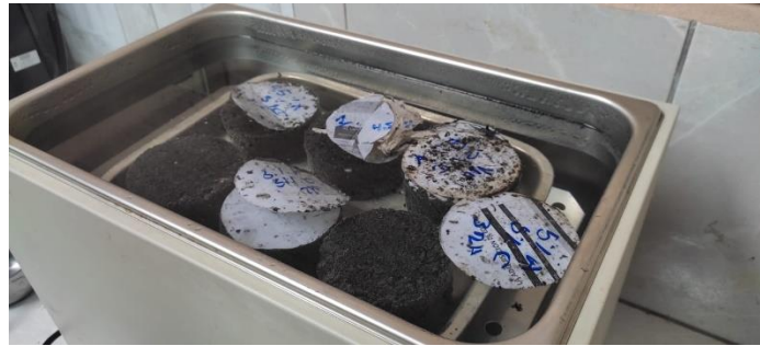
Ilustración 3.34. Briquetas en baño María previo al ensayo de flujo y estabilidad.
