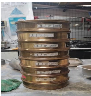
Ilustración 3.5. Ubicación de cada uno de los tamices. Fuente: Elaboración propia.
