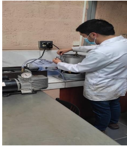
Ilustración 3.32. Ensayo Rice para determinación de vacíos equipo de extracción de aire.
