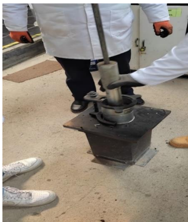
Ilustración 3.15. Pedestal de compactación. Fuente: Elaboración propia.
