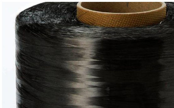
Figura 1.2. Fibra de carbono de alto rendimiento hecha de poliacrilonitrilo (PAN)
