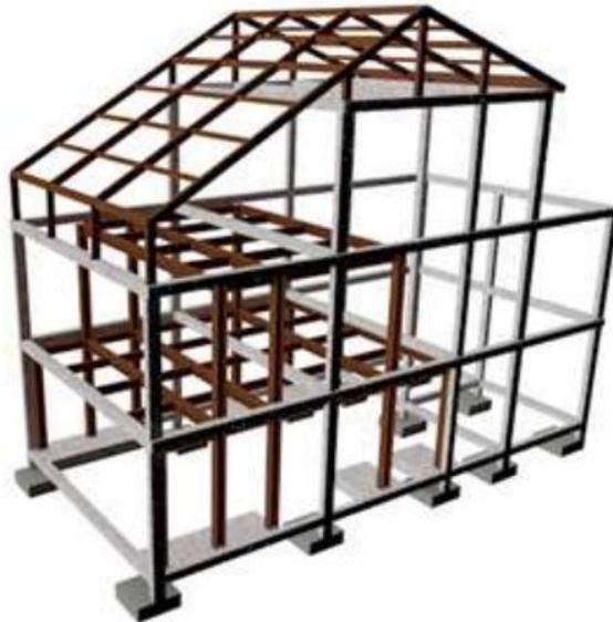
*Ilustración 4.3.1 Estructura metálica de reforzamiento.
