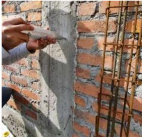
Ilustración 2.1 toma de medidas con esclerómetro.
