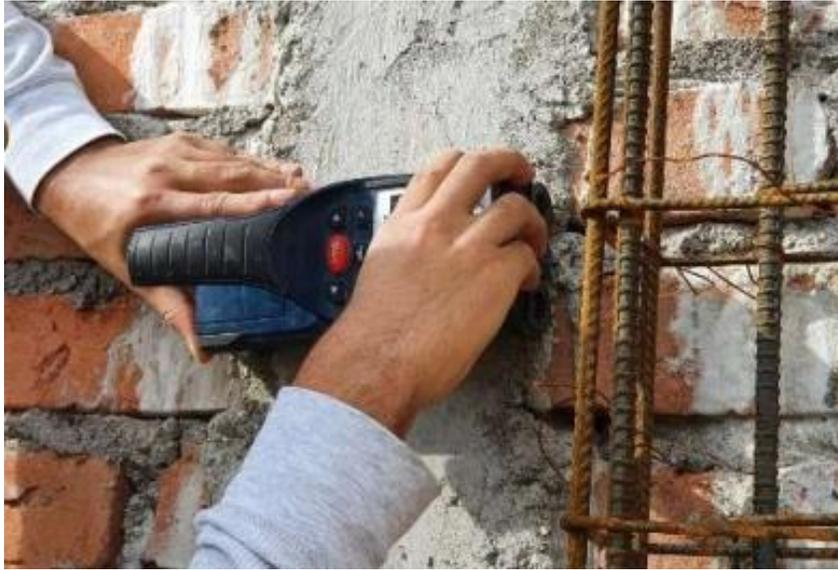
*Ilustración 2.2 recopilación de datos con el escáner de armados.
