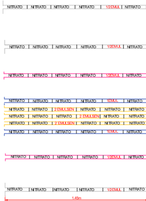
Figura 3.11 Secuencia de carguío de explosivo.
