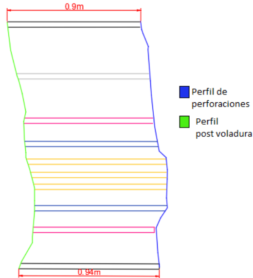
Figura 3.22 Perfil de avance post voladura.
