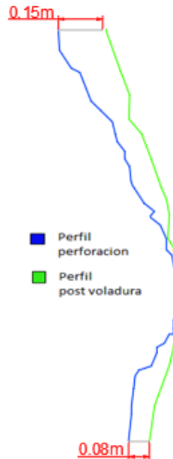
Figura 3.14 Perfil del frente de trabajo post voladura.
