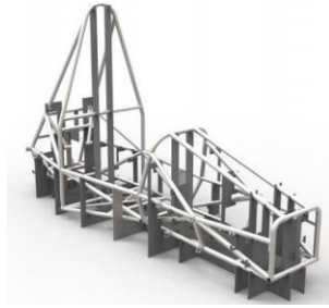
Figura 6 Fixtures en un chasis monocasco
