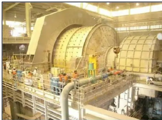
Figura 1.8 Molino autógeno y semiautógeno
