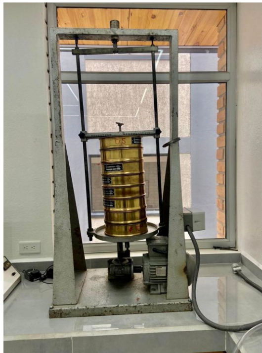
Figura 3.13 Tamizado de las muestras para análisis granulométrico
