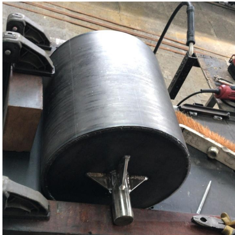
Figura 2.3 Tambor listo para ser ensamblado
