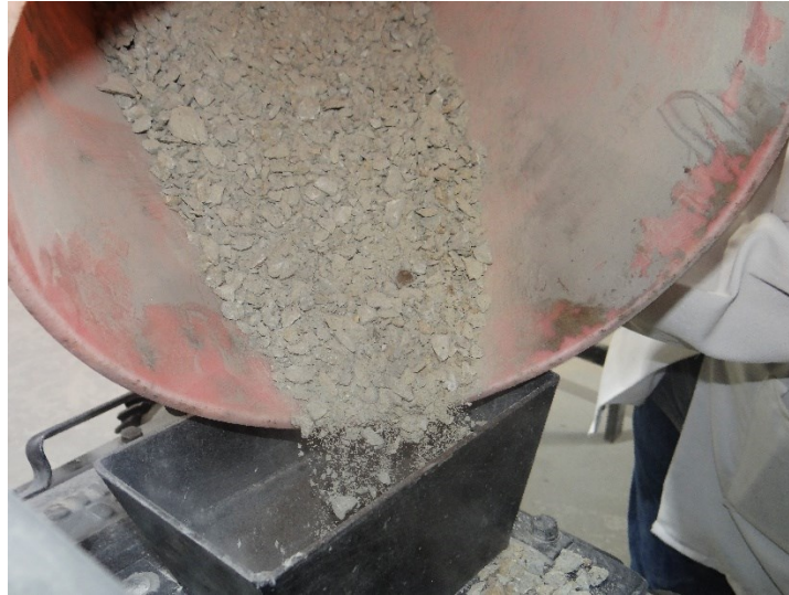
Figura 3.11 Alimentación de trituradora de rodillos
