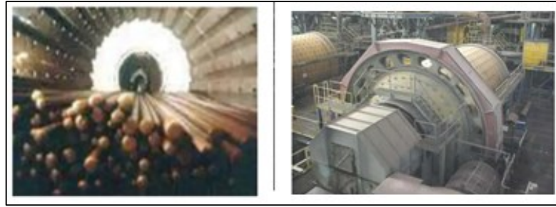
Figura 1.2 Tipos de molinos convencionales
