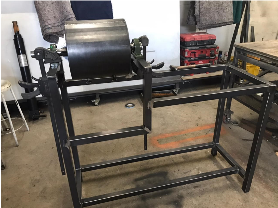
Figura 2.4 Cilindro montado en la estructura metálica
