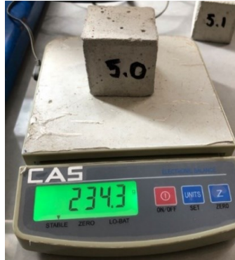
Figura 2.28. Peso del mortero luego de salir del horno.
