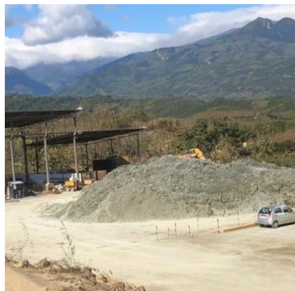
Figura 1.13. Acoplamiento del relave minero luego de extraer de las piscinas de sedimentación
