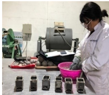
Figura 2.17. Aplicación de antiadherente en los moldes.
