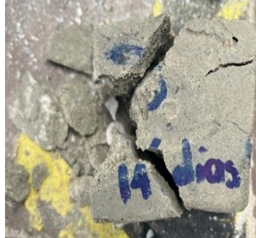
Figura 2.26. Probeta luego de soportar la carga máxima ejercida.
