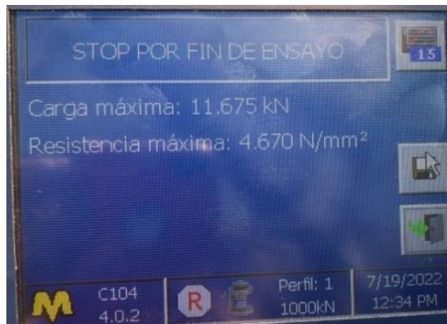
Figura 2.27. Datos directos marcados por la prensa hidráulica.
