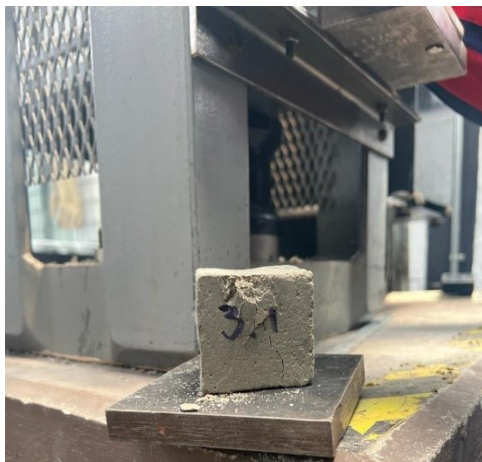
Anexo 9. Rotura probetas de muestra #3
