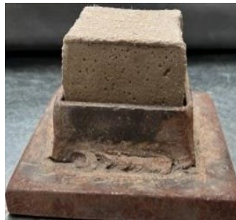
Figura 2.22. Probeta colocada en placa de medición de 50 mm 3 .
