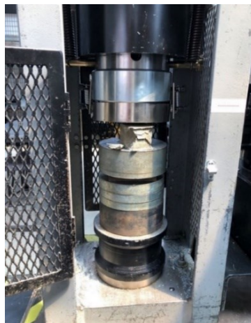
Figura 2.25. Probeta colocada en el centro de la prensa hidráulica.
