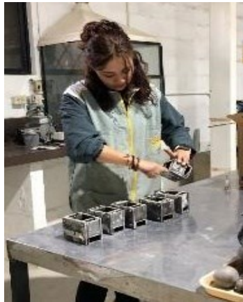
Figura 2.15. Aplicación de antiadherente en los moldes.
