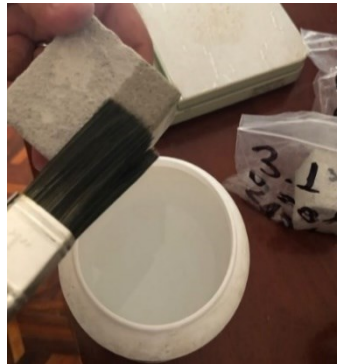
Figura 2.29. Aplicación de impermeabilizante en el mortero.
