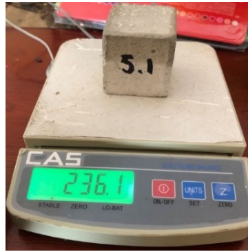
Figura 2.30. Peso del mortero luego de aplicar la capa impermeabilizante.
