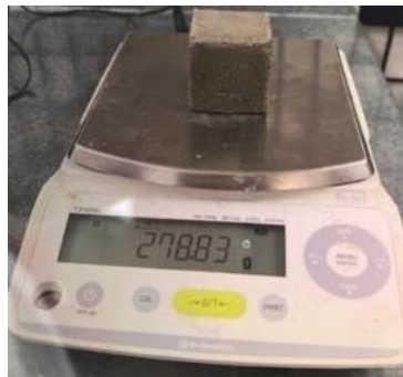
Figura 2.23. Peso del mortero antes de la rotura.
