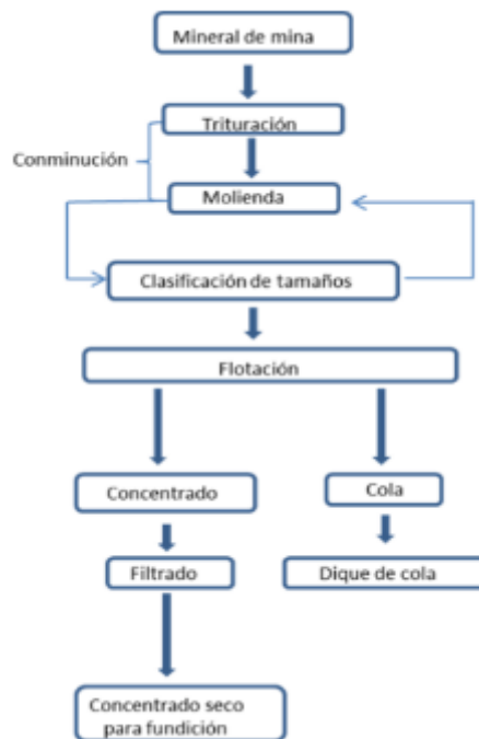
Figura 1.4. Diagrama de flujo para beneficio de minerales.
