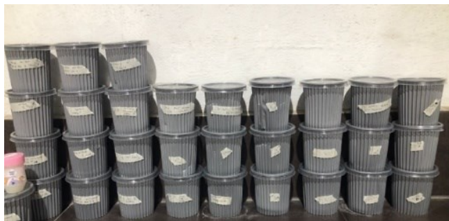
Figura 2.21. Muestras sumergidas en agua hasta los 7, 14 y 28 días.
