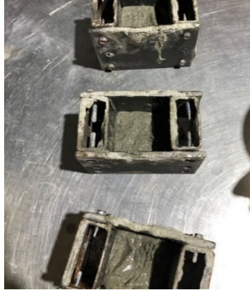
Figura 2.18. Primera capa de mortero de aproximadamente 25 mm 2
