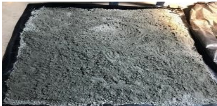
Anexo 2. Recolección del cobre después del proceso de flotación
