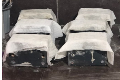
Figura 2.20. Muestras cubiertas con un paño húmedo
