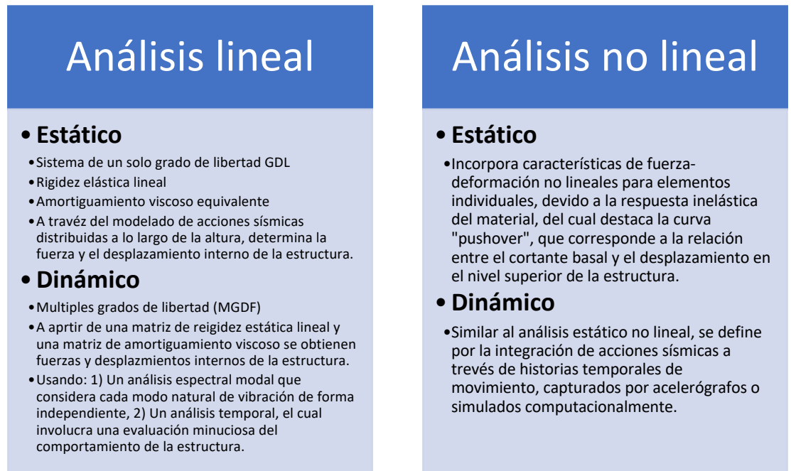
Figura 2.4. Análisis lineal y no lineal (estático y dinámico). Fuente: (Bonnet Díaz, 2003, pág.14), elaboración propia.
