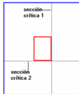
Fig. 50: Diagrama en planta del plinto Fuente: Romo Proaño (2008)
