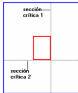
Fig. 64: Diagrama en planta del plinto Fuente: Romo Proaño (2008)
