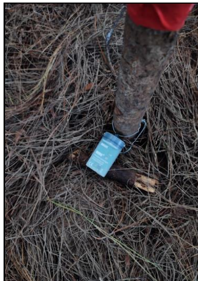
Anexo 4. Instalación y muestreo de los data loggers para la obtención de datos microclimáticos.
