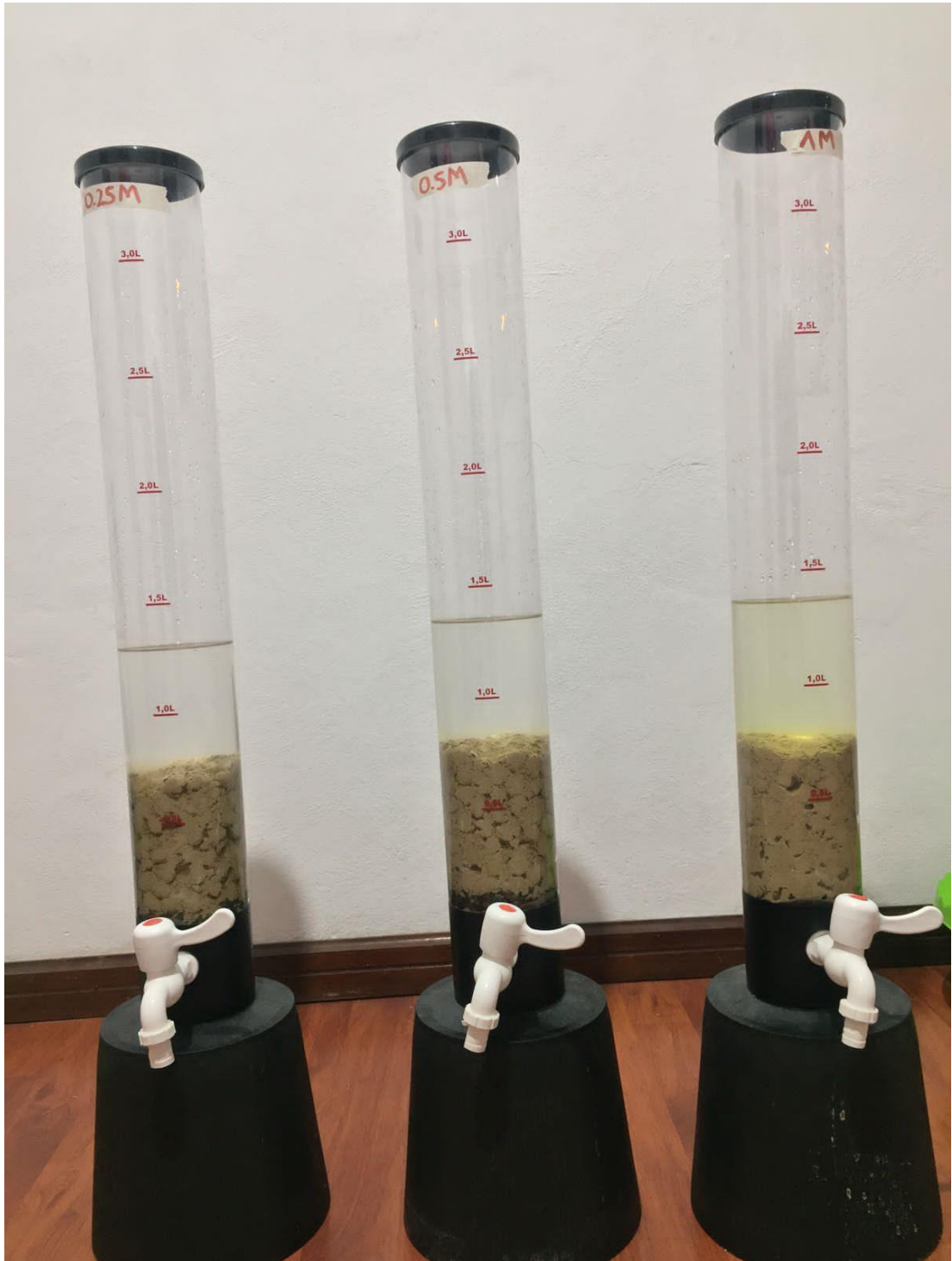
Anexo 9 Columnas después de 8 horas de lixiviación.
