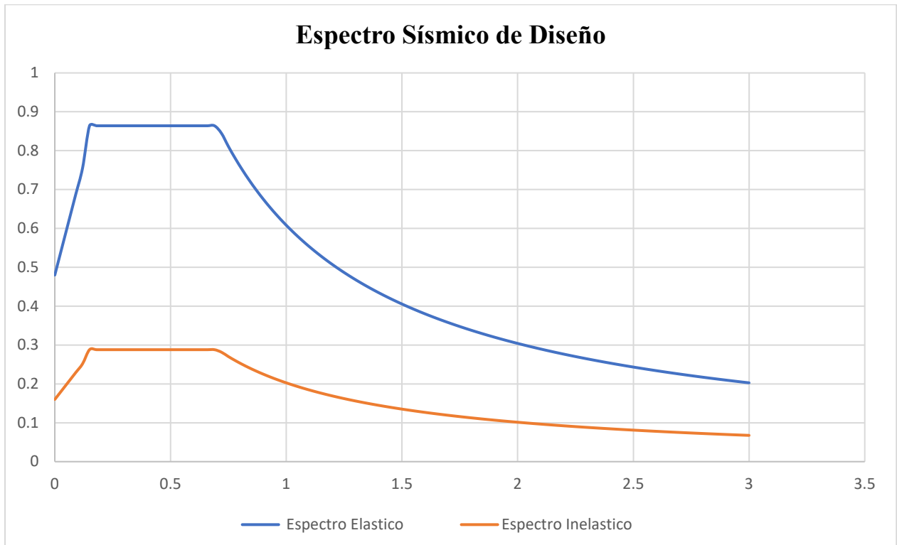
Figura 3.7 Espectro de diseño NEC-15-SE-DS
