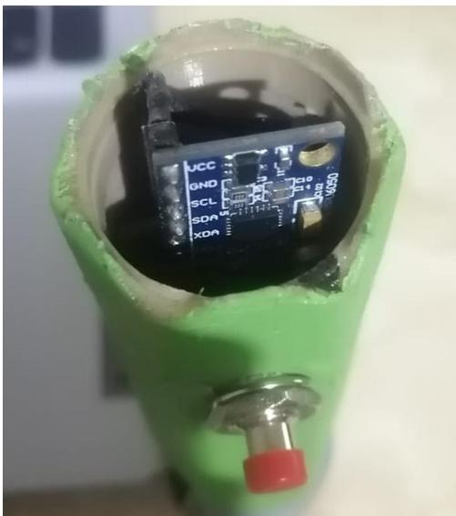
Fig. 34. Posición del IMU dentro del lápiz3D.
