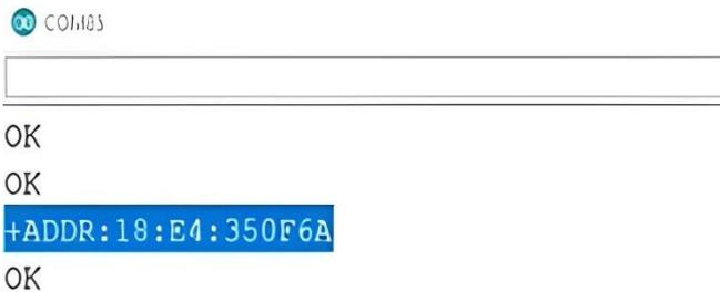
Fig. 30. Ingreso de comando AT para configurar el Bluetooth.
