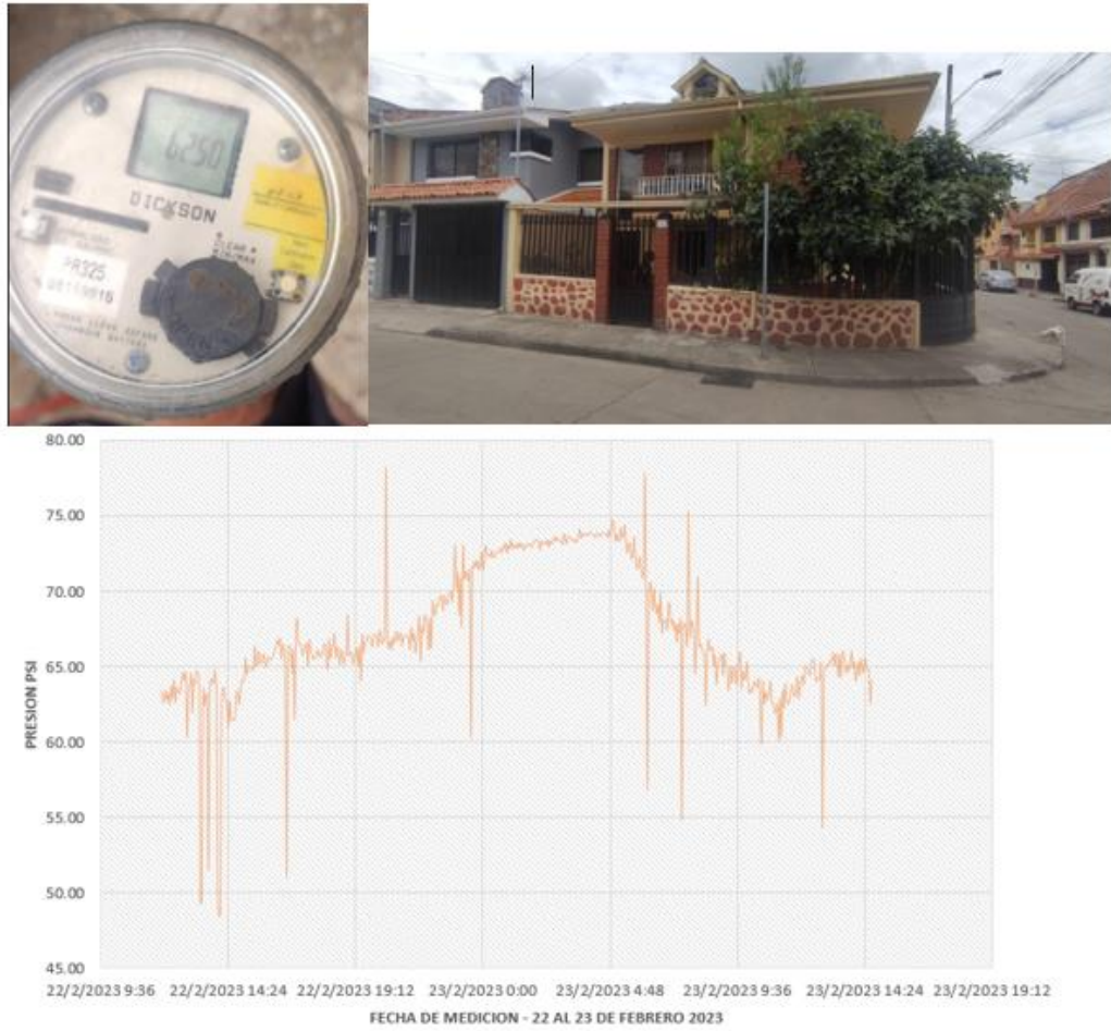
Figura 19. Registro de presión en punto 9, subsector 9.
