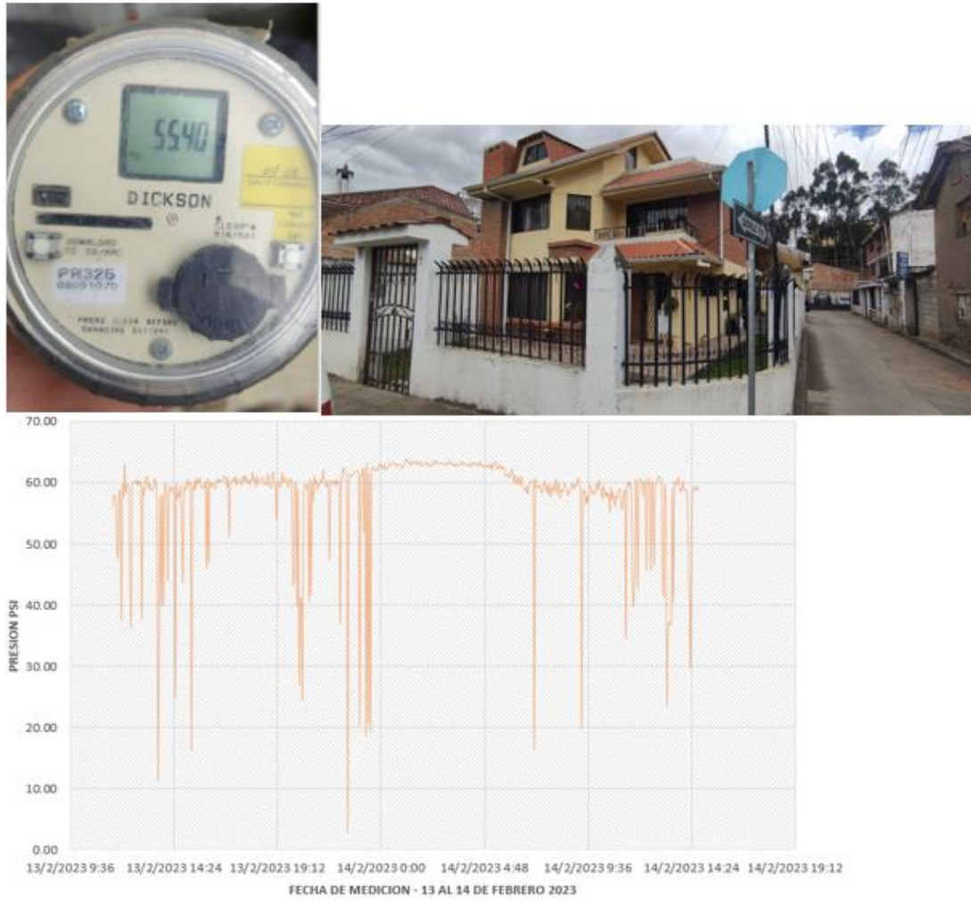
Figura 14. Registro de presión en punto 4, subsector 5.
