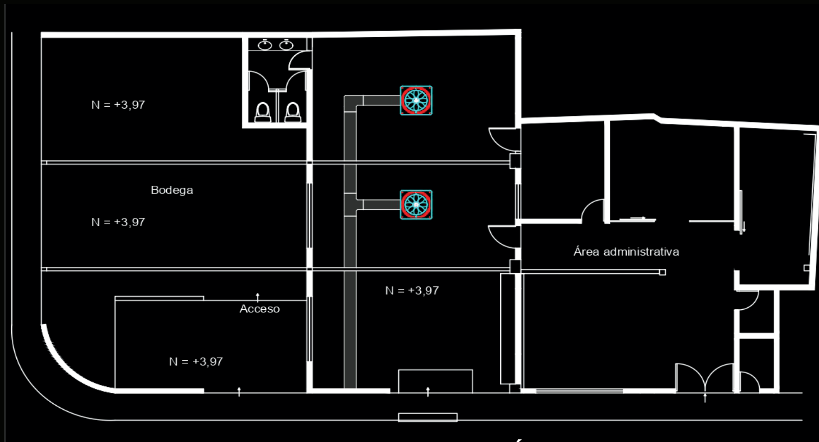
PLANTA DE VENTILACIÓN
