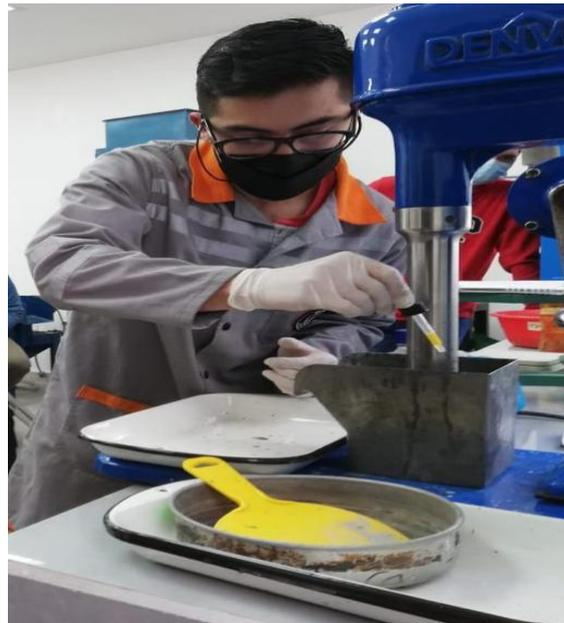
**Figura 3.2.** Adición del activante por medio de un gotero.
