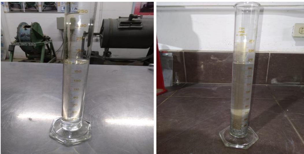
**Figura 2.2.** Cálculo de densidad del material mediante el principio de Arquímedes.
