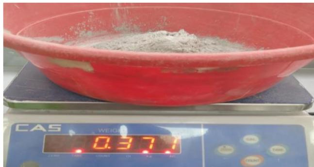
**Figura 2.4.** Peso de masa del material necesario para alimentar del sistema (0.371kg).
