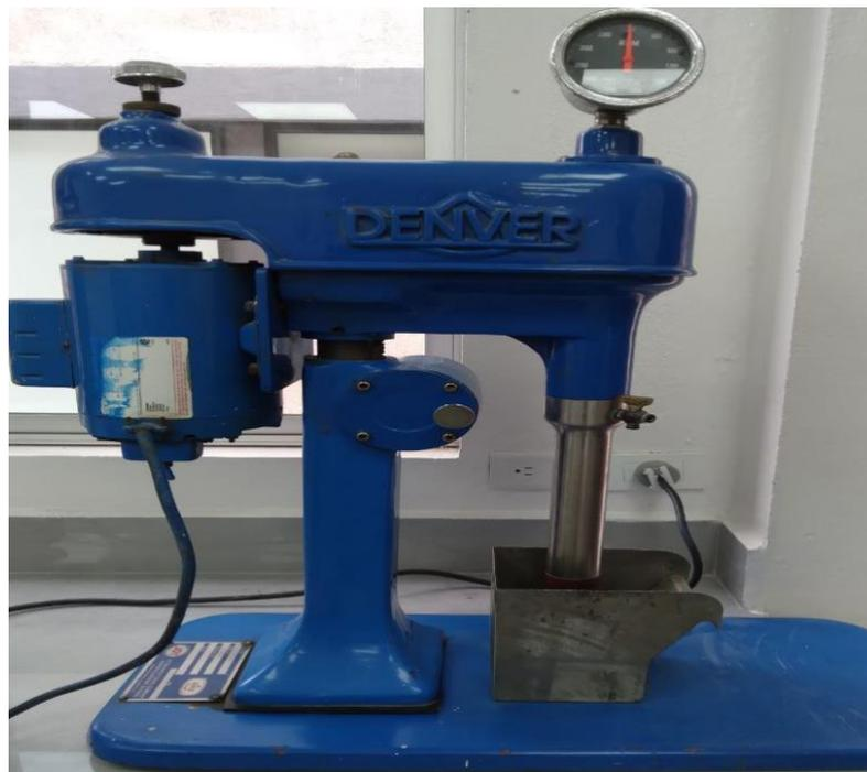
**Figura 3.1.** Máquina de flotar tipo DENVER.
