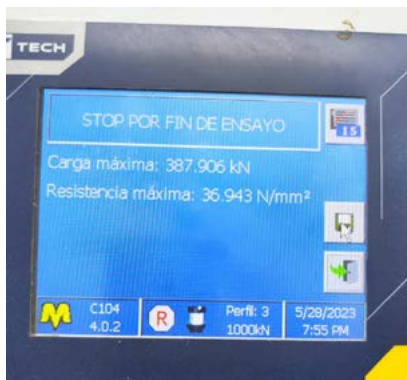
Imagen 12: Resultados de máquina de compresión
