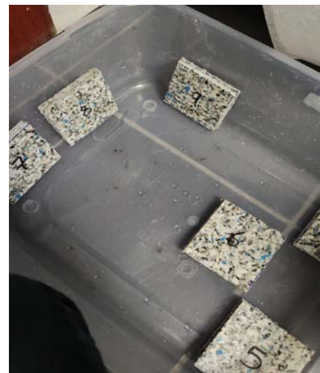
Imagen 19: Placas en vertical sometidas en agua
