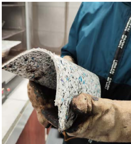
Imagen 24: Placa sometida a 1.30h en horno
