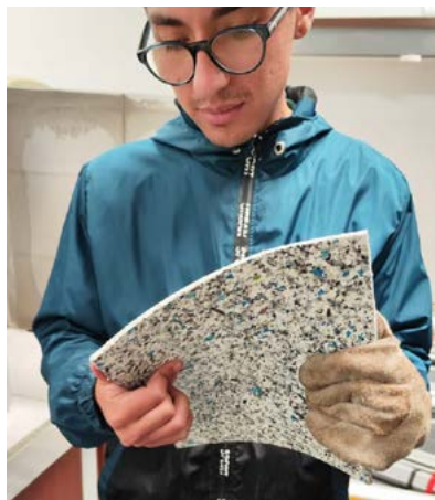
Imagen 23: Placa sometida a 1 hora en horno
