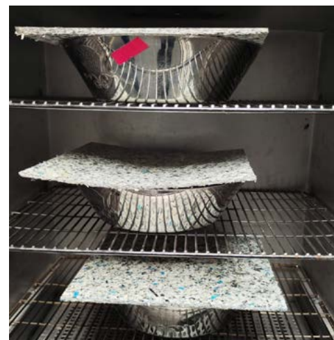
Imagen 21: Placas sometidas en horno
