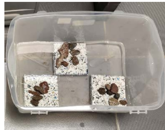
Imagen 18: Placas sometidas en agua
