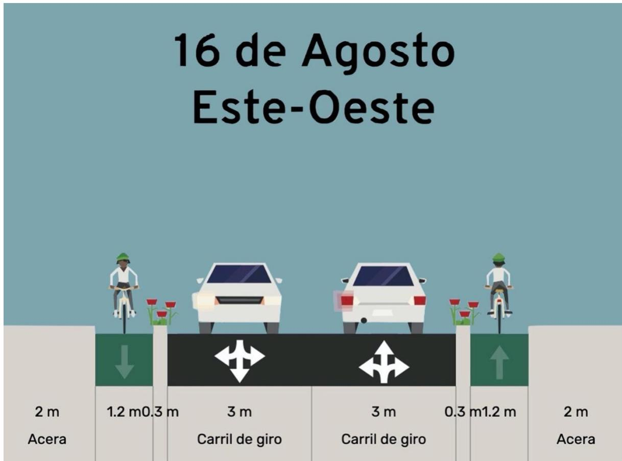
Las ciclovías adosadas a las aceras derechas según el sentido de circulación buscan mantener la conexión en intersecciones con las otras ciclovías que forman parte de la red, previniendo cruces preligrosos.
