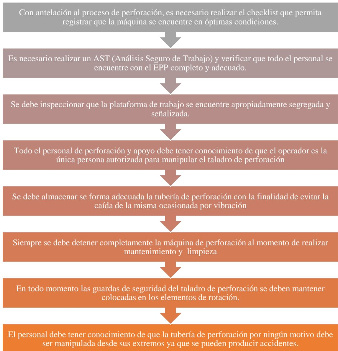
**Figura 2.7** Medidas de seguridad aplicables al proceso de perforación
