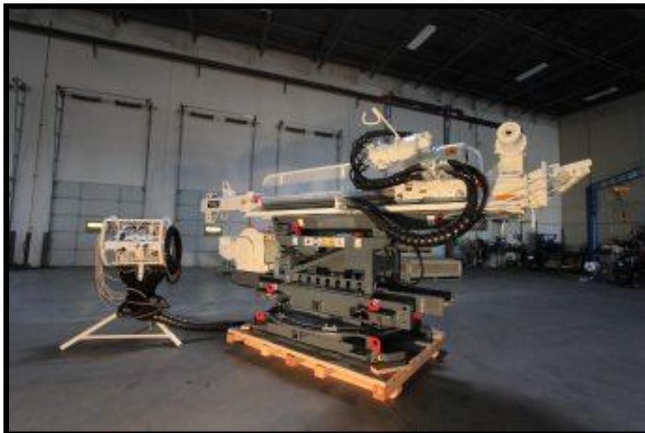
**Figura 1.5** Perforadora a diamantina LM-75
