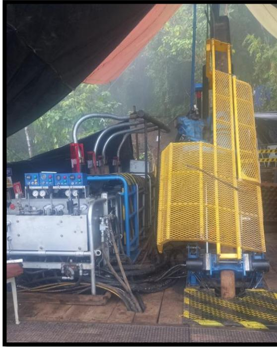
**Figura 1.3** Perforadora a diamantina Hydracore 4000
