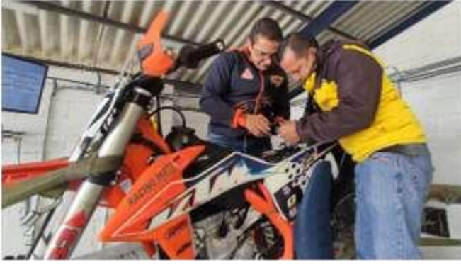
Fig 6 Instalación de la ECU programable.
