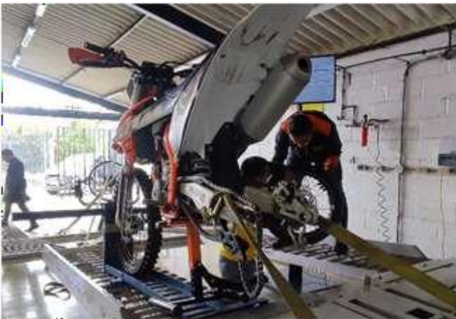
Fig 7 Cambio del kit de tracción.
