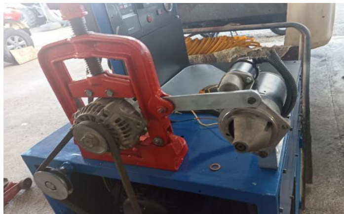
Figura 18 Banco de pruebas motores de arranque y alternadores
