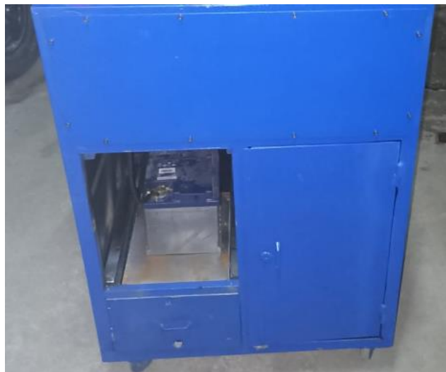
Figura 14 alojamiento de baterías
