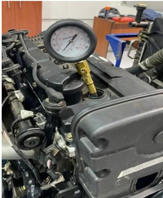
Nota: Utilice siempre una batería completamente cargada para obtener un régimen del motor de 200 rpm o más, esta medición debe realizarse en el menor tiempo posible.
