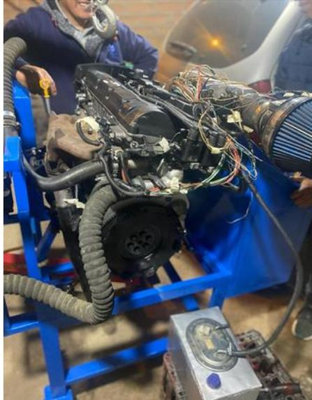
Una vez completado el montaje del sistema de encendido y combustible, colocar lubricante, el filtro y refrigerante para poner en marcha el motor.
