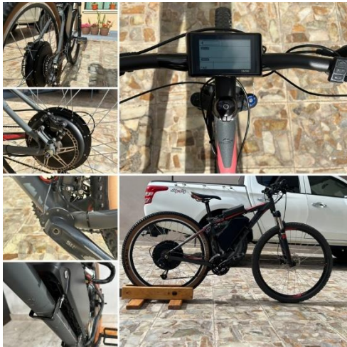
Figura 12: Instalación de componentes del kit.
