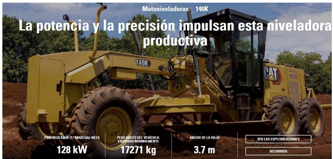
Imagen 233 Especificaciones técnicas de la motoniveladora usada en el relleno y la explanación del terreno.
