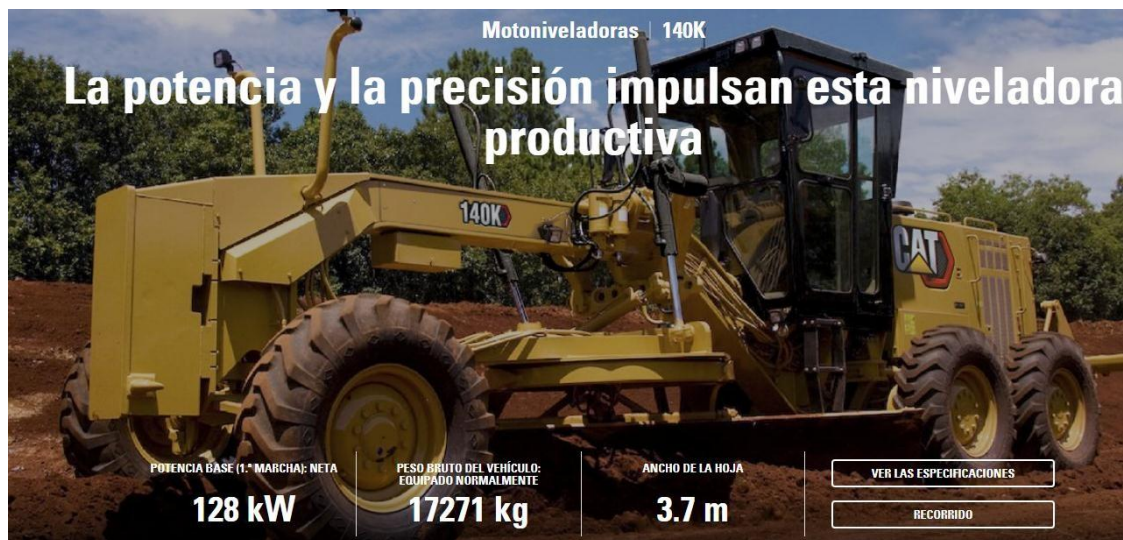
Imagen 210 Especificaciones técnicas de la motoniveladora usada en la explanación del terreno. Fuente: Caterpillar
