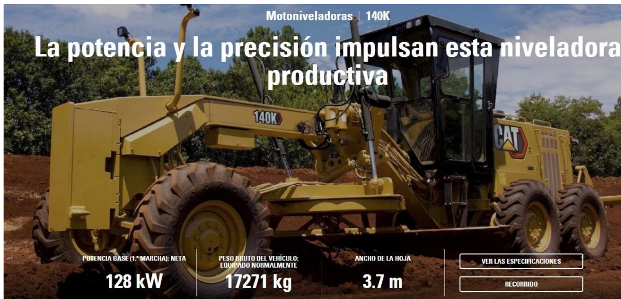
Imagen 184 Especificaciones técnicas de la motoniveladora usada en el desbroce. Fuente: Caterpillar
