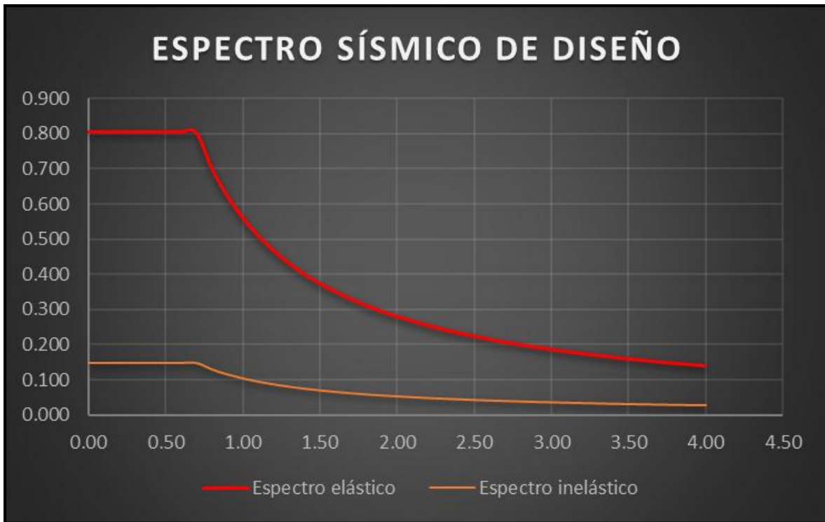
Imagen 15 Representación del espectro de diseño y el espectro reducido. Fuente: Nicolás Pozo
