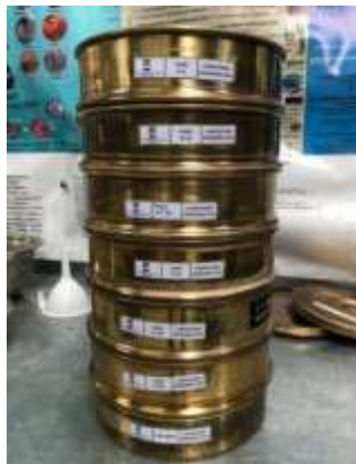
Figura 2.4. Tamices adecuados para los áridos finos según la Norma
