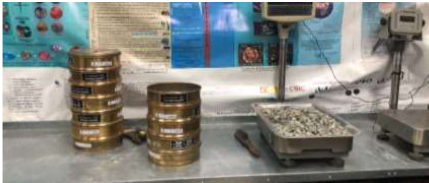
Figura 2.3. Tamices adecuados según la Norma
