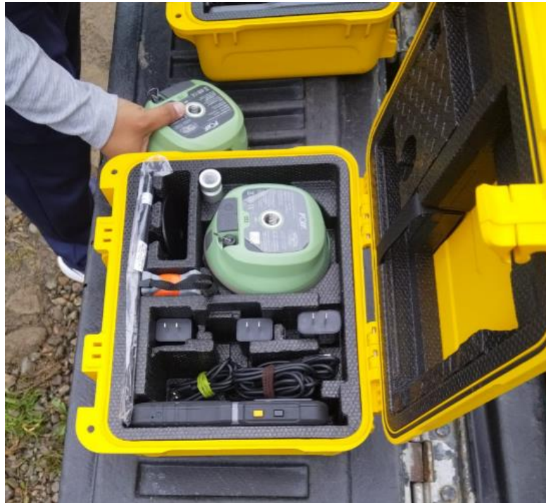
Figura 1-11 Equipo RTK para realizar el levantamiento topográfico Fuente: Elaboración propia
