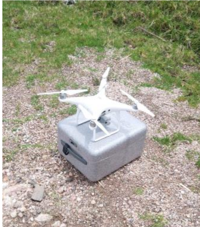
Figura 1-17 Dron con el cual se realizará la toma de orto fotos de toda la comunidad para la recolección de datos.
