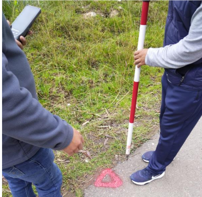
Figura 1-15 Señalización de puntos de control para el levantamiento topográfico Fuente: Elaboración propia
