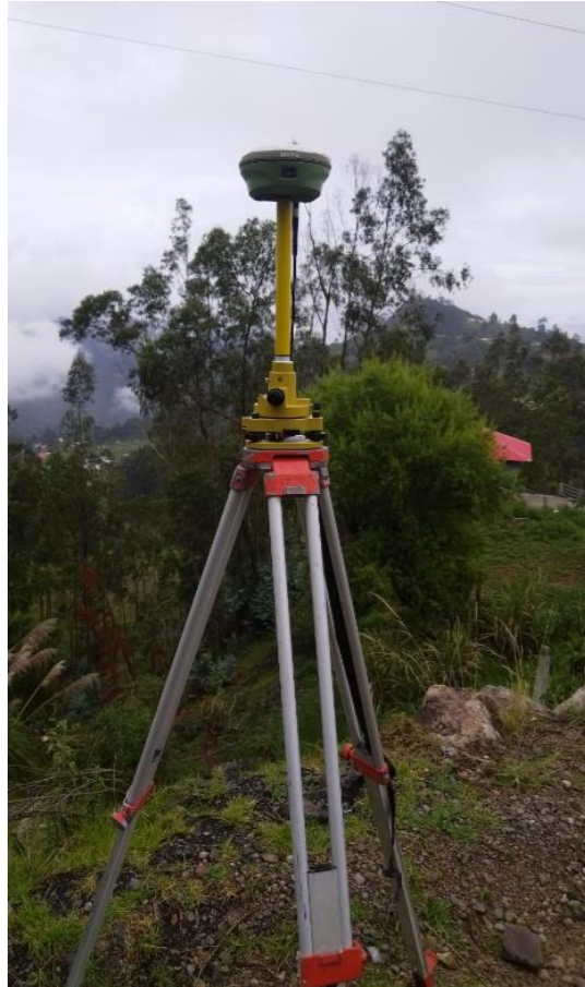
Figura 1-13 Base 1 del RTK ubicado en la parte superior de la comunidad Fuente: Elaboración Propia
