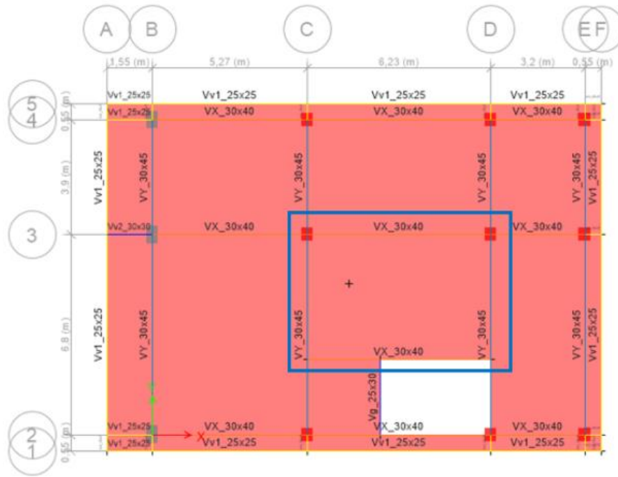
Figura 3.27. Paño analizado en condición más desfavorable.
