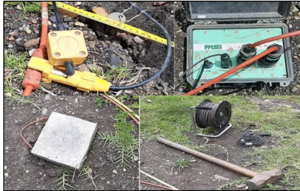
Figura 2.2 Equipo PASI para refracción sísmica
