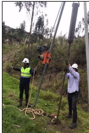
Figura 2.16 Ensayo de SPT en la zona de estudio
