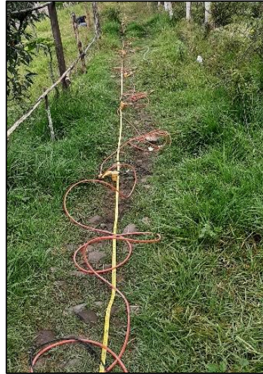
Figura 2.3 Tendido del cable sísmico con 24 geófonos
