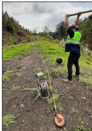
Figura 2.4 Fuente de energía sísmica ( shot ) y registro de datos
