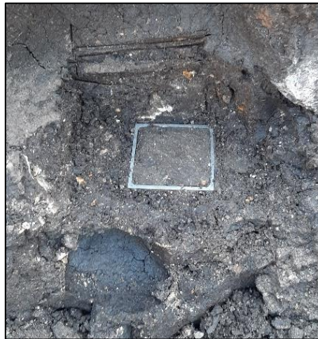
Figura 2.18 Extracción de muestra inalterada para corte directo
