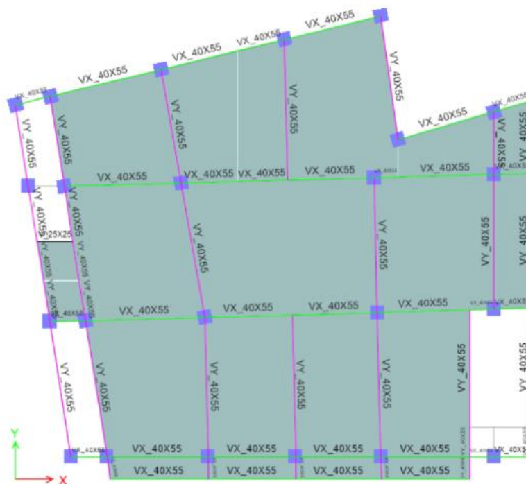
Figura 1. Pórticos resistentes a sismos N+3.20
