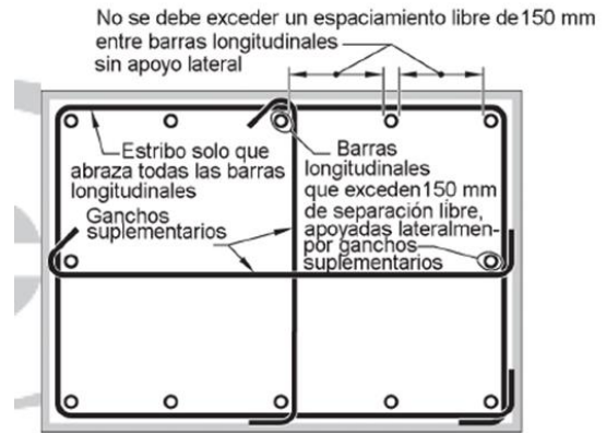
Figura 9: Separación de estribos
