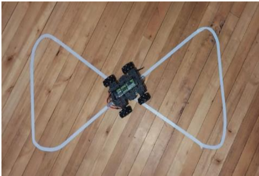
Fig. 17. Trayectoria de prototipo real sobre lemniscata.
