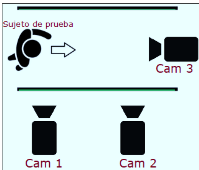
Fig. 9. Posicionamiento de las cámaras respecto al sujeto de prueba.
