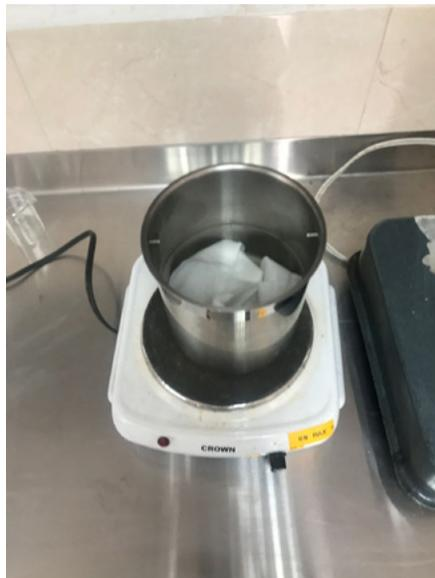
Llevar a ebullición para tinturar a una temperatura de 80 °C por 30 min.
