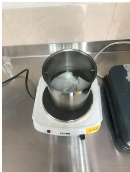
Llevar a ebullición para tinturar a una temperatura de 80 °C.
