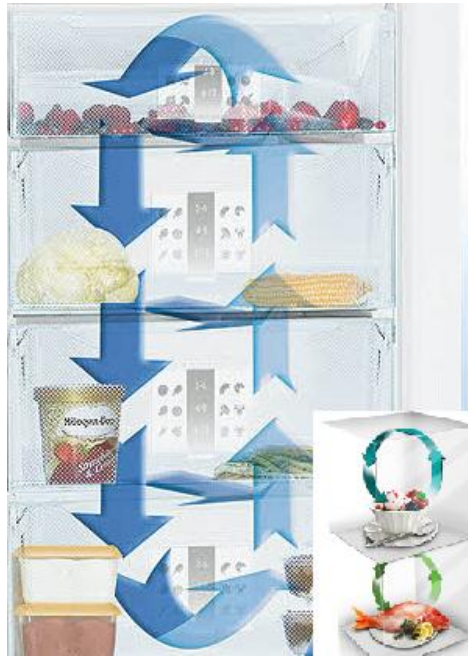
Figura 46. Circulación del aire frío dentro de la refrigeradora
