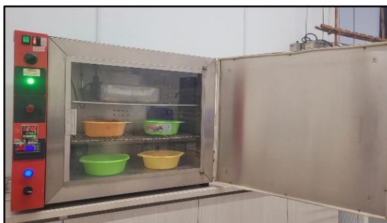
Figura 2.2 Germinador utilizado en el proceso germinativo de las semillas
