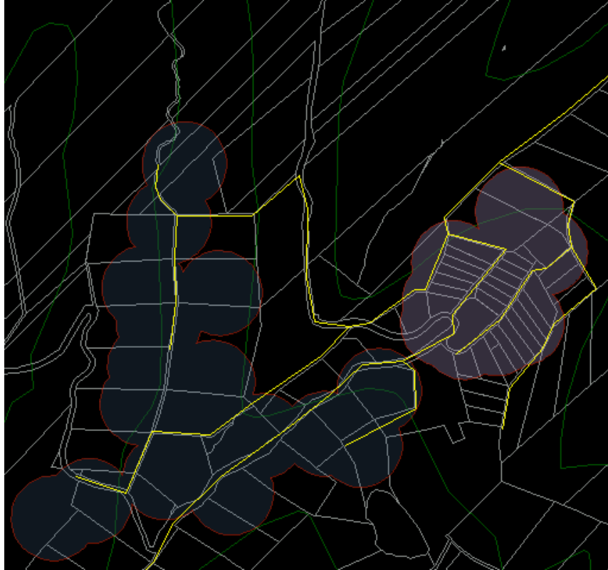
Figura 2.1. Prediseño del sistema de alcantarillado ramificado
