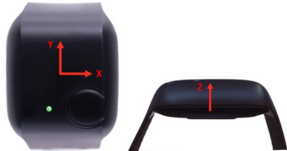
Fig. 1. Orientación de los ejes x, y, z del acelerómetro de la pulsera E4 [28].
