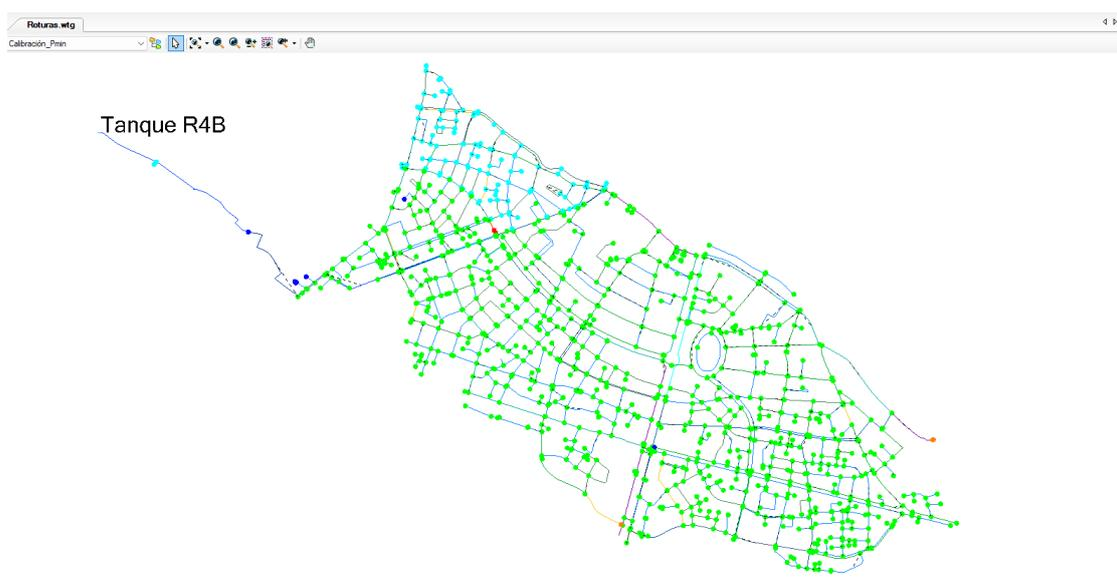
Figura 4-7 Rotura en la tubería ID:3108
