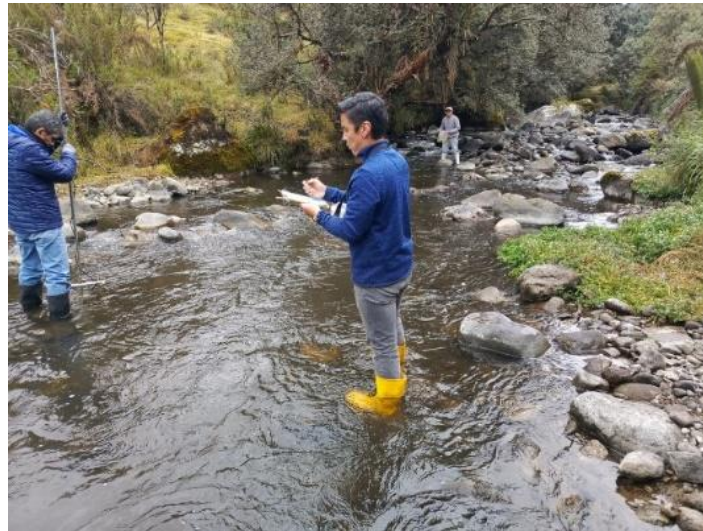
Figura 11. Comparación de métodos: Trazador de sal y método de molinete
