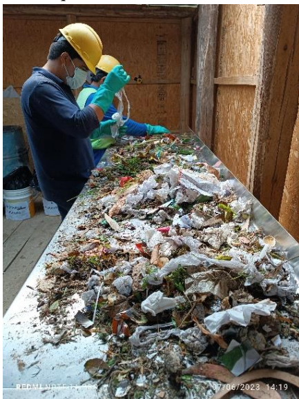
Figura 23 Separación manual de residuos.
