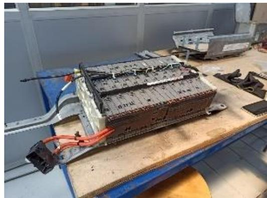
Fig. 1 batería de Ni - MH
