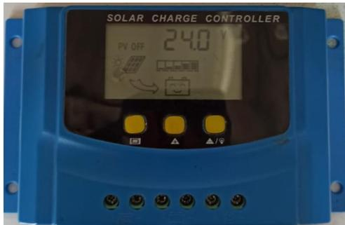
Fig. 15 Configuración del regulador de carga solar – corte de voltaje de los paneles solares
