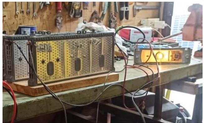
Fig. 6 Proceso de descarga a baterías de Ni - MH
