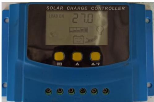
Fig. 16 Configuración del regulador de carga solar – encendido de la carga de las baterías
