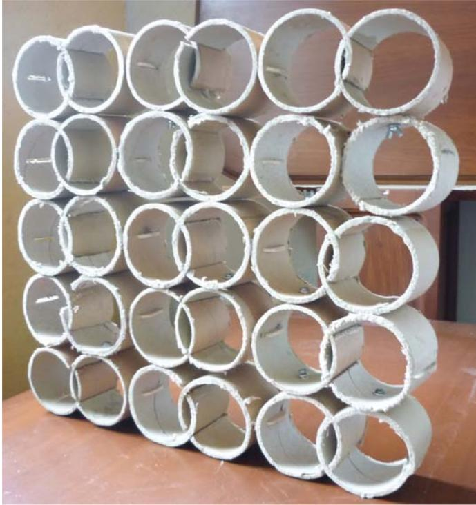
Construida la estructura, el resultado que se esperó no fueron satisfactorios ya que el módulo presentó deformaciones, inestabilidad, al terminar.
