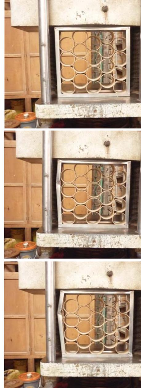
El módulo está conformado por secciones del tubo, por lo cual no alcanzó la misma fuerza, que se logró con el módulo 1. A pesar de que la perfleria es una gran ayuda. Su fuerza: 687 kg
