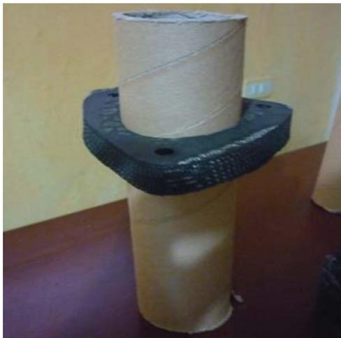
Para un crecimiento horizontal, las piezas son diferentes, ya que están diseñadas, para que encajen en el diámetro exterior del tubo.
