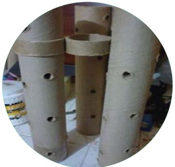
En este tubo se realizaron perforaciones, con un taladro eléctrico, el tiempo para realizar las perforaciones es de 3 min, el cual dependerá del largo que tenga el tubo.
