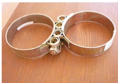
Podemos observar en la fotografía, la vinculación de las dos abrazaderas, con un solo tornillo, arandela y tuerca.
