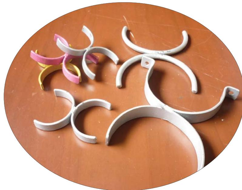
La experimentación con abrazaderas industriales, platinas metálicas, madera, varillas; brindan resultados favorables, y al mismo tiempo desfavorables; entre las primeras su uso nos permite mayor durabilidad, y entre las segundas tenemos el costo que es elevado y la elaboración de ellas requiere bastante tiempo. Por lo anotado es recomendable trabajar con tubos que no tengan un largo mayor a 0.10cm, con el fin de buscar mejores resultados y estabilidad en las estructuras.
