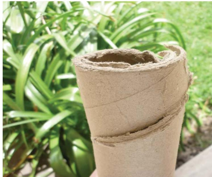
En este tipo de tubos, a diferencia de los otros que tienen una textura lisa, se puede observar como sus capas están constituidas de forma espiral, y después de cumplir su función la mayoría tiene daños y sus capas se desprenden.
