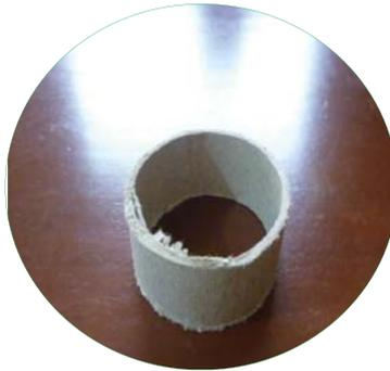
Son secciones del propio tubo de cartón, existen dos maneras para obtener este corte; la primera con una sierra eléctrica y la segunda con una sierra manual.
