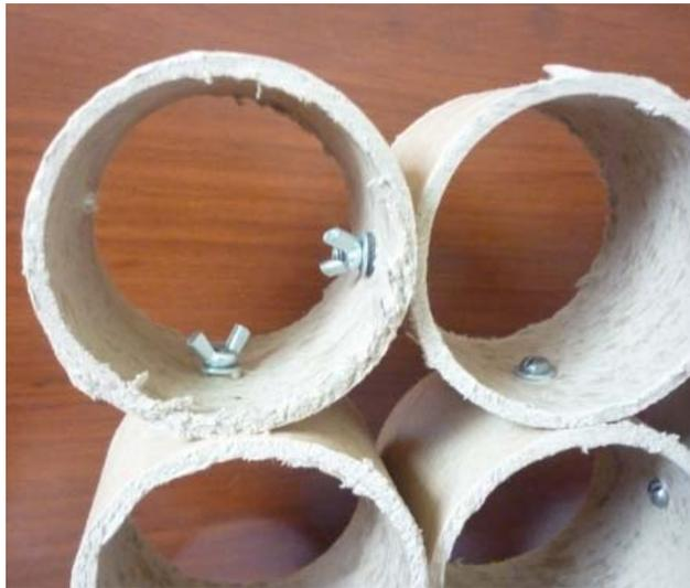
Este módulo es el más estable, para su elaboración se realizó perforaciones que nos permiten atornillar, cada argolla tiene dos perforaciones.
