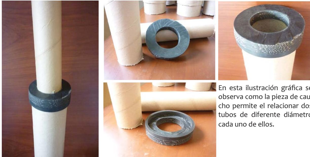
En esta ilustración gráfica se observa como la pieza de caucho permite el relacionar dos tubos de diferente diámetro cada uno de ellos.
