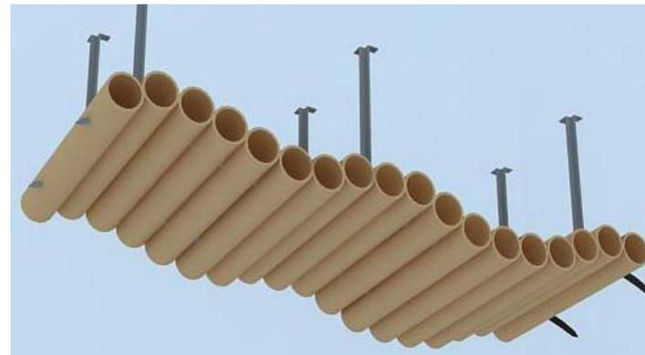
Están construidas de 1.20 x 0.60m, su esqueleto es dos varillas de 8mm. Son varillas cilíndricas, y cada una de ellas tiene ondulaciones para un diseño dinámico. Igual que los módulos de cable de acero los tubos de cartón tienen dos perforaciones para poder conectar las varillas con los tubos de cartón. La instalación es mediante un ángulo para gypsum, el mismo que ira sujetado mediante tornillos para gypsum en la estructura del cielo raso existente.
