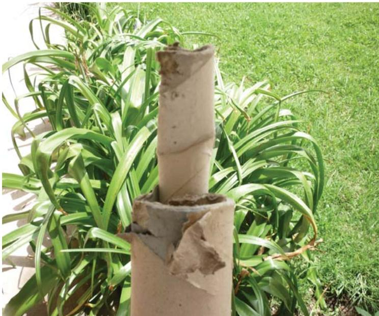
En la imagen se puede observar como las puntas, de los tubos de cartón se encuentran en mal estado, por el contacto con el agua, y humedad, como resultado de este las capas de papel se desprenden.
