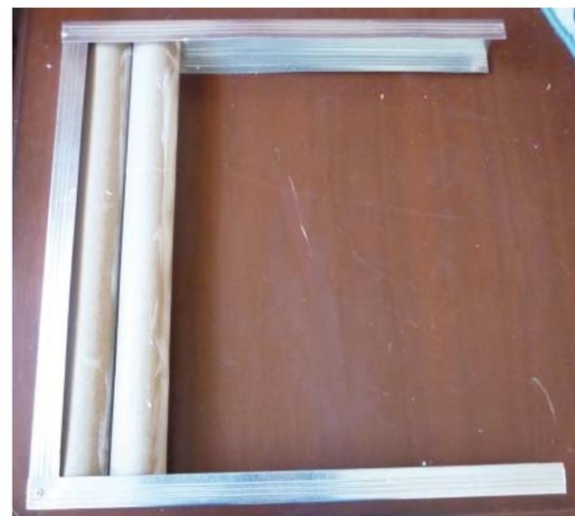
Para la elaboración del módulo del tubo de cartón, es necesario que entre tubo y tubo vayan encolados a fin de obtener mayor firmeza, y que, para armar el módulo el marco general debe constar inicialmente de sus tres lados, y el último marco sera colocado al final.
