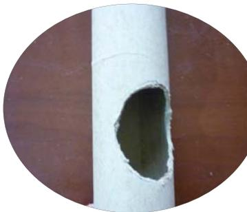
En esta perforación se puede realizar de dos maneras, la una es manualmente con una tijera y cuchilla, es dificultoso y requiere de tiempo, y la segunda en talleres de carpintería, con una broca grande.
