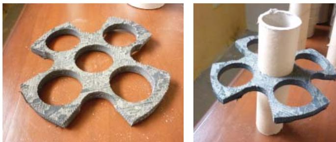
Se experimentó con caucho proveniente del reciclaje de los neumáticos; en nuestra ciudad existen artesanos que se dedican a la elaboración de elementos a partir de este material. Es por esta razón que propongo una alternativa para el tubo de cartón; en donde los dos materiales mantengan una vinculación a partir del caucho, se diseña una serie de piezas alternativas para crecimientos entre los tubos.
