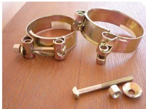
Para vincular las dos abrazaderas, retiramos los componentes de una de las abrazaderas, las cuales no se necesitan.
