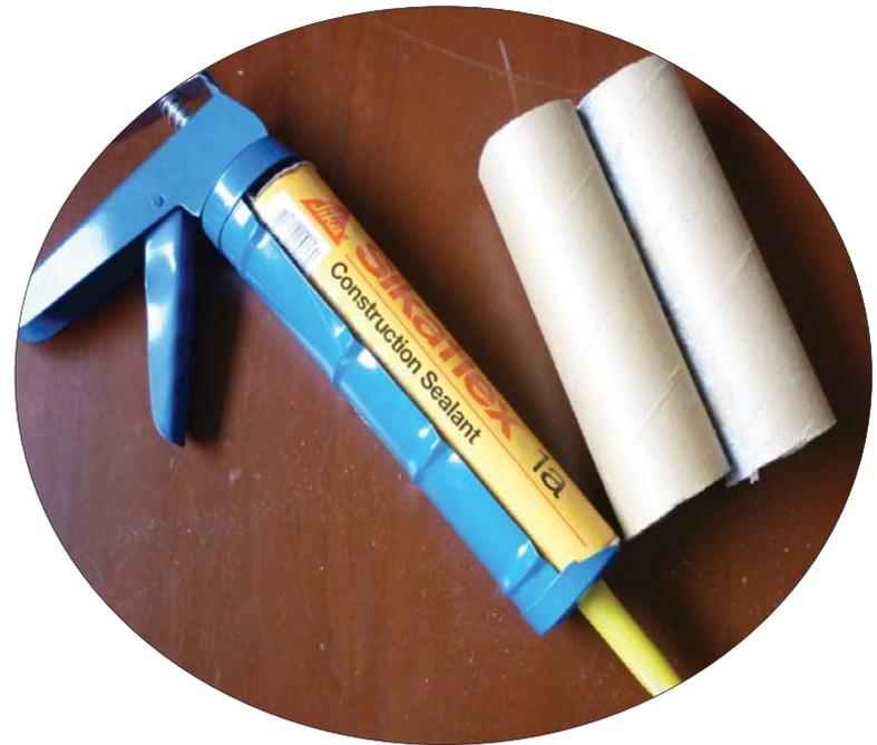
Como conclusión podemos destacar que es muy importante, saber que al unir los tubos de cartón, no tenemos una superficie, que nos permita esparcir con gran facilidad el pegamento, contamos con una sección del tubo, la cual vendría a ser una línea recta, en donde el pegamento se va colocar.
