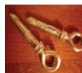
Las argollas de anclaje con pernos de presión, van ancladas a la pared. Tienen una argolla para poder cruzar el cable de acero, y tensar el módulo de extremo a extremo.
