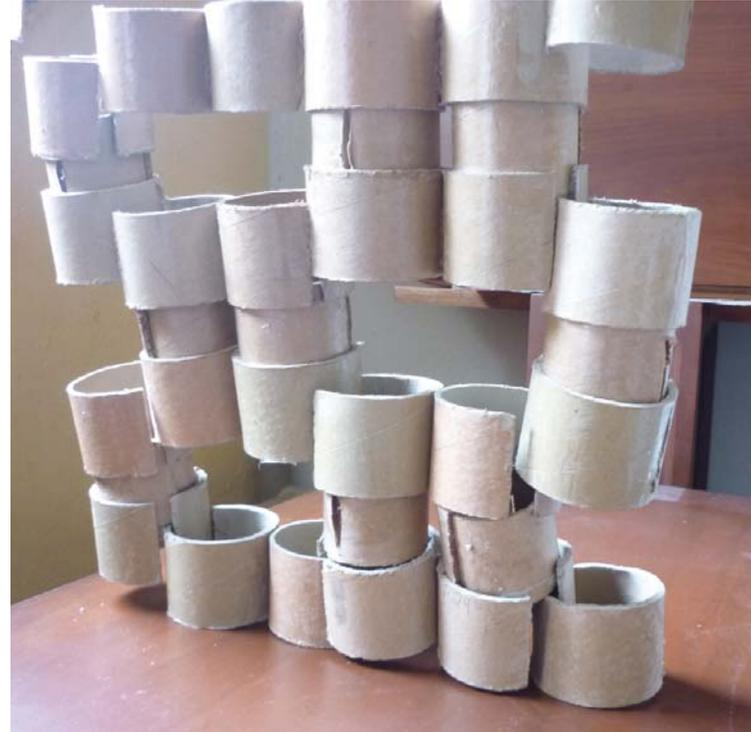
La construcción para este módulo, se emplearon secciones del tubo (argollas) con galletas. A comparación del módulo 1, la inestabilidad es mayor, pues cada sección tiene dos cortes y esto hace que el tubo pierda fuerza y se vaya deteriorando. La debilidad es notable ya que recibe presión por las argollas que son introducidas en el interior.
