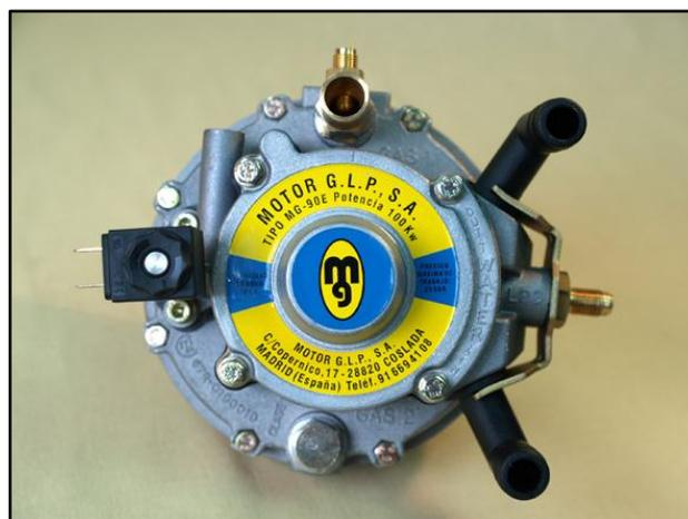
**Figura 2.9.** Reductor – Vaporizador.
