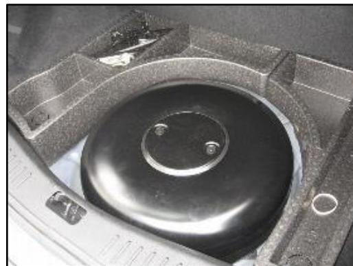
**Figura 4.6.** Depósito toroidal de GLP.
