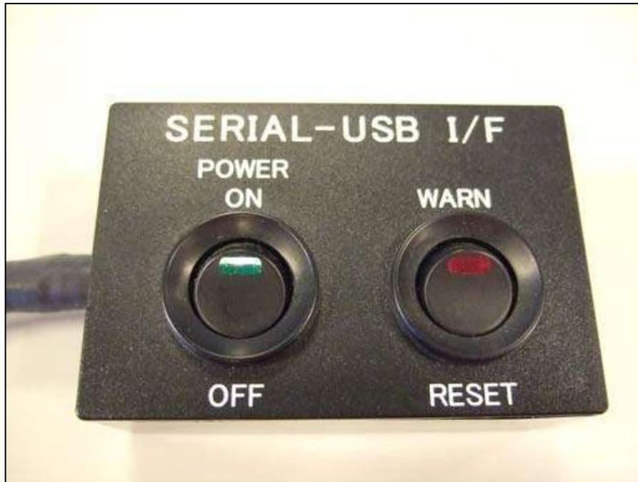
Figura 2.5. UNIDAD SERIAL USB I/F
