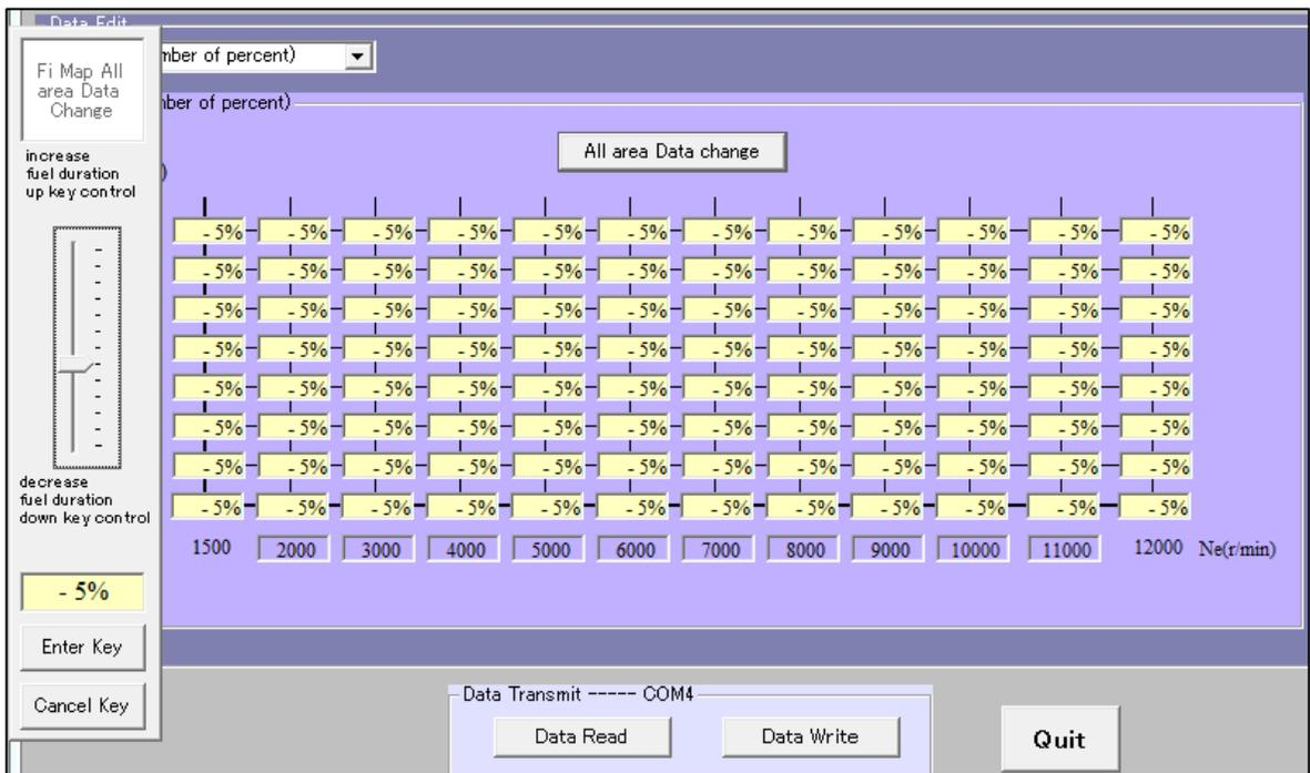
Figura 2.14. COMANDO DE CAMBIO DE DATOS
