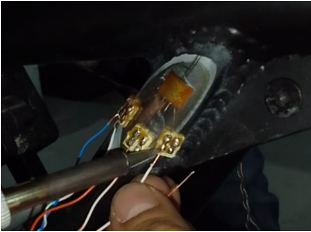
Figura 4: Proceso de soldadura de los hilos de la galga.
