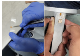
Figura 9: Pegado de la galga en la viga.
