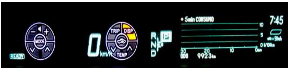
Figura 37.1: Panel de instrumentos indicando: consumos de combustible en lapsos de 10 minutos, comandos del volante y velocímetro.
