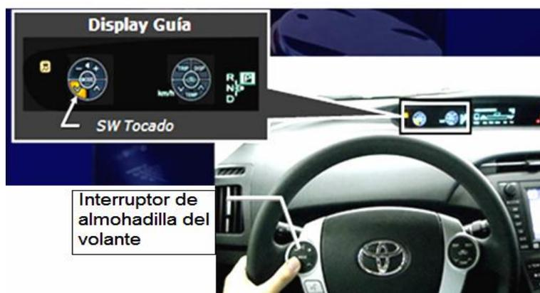
Figura 40: Mandos del volante y su ubicación en la pantalla del panel de instrumentos.
