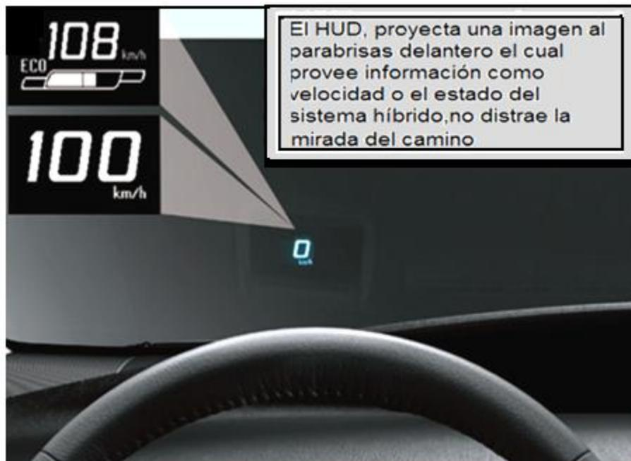
*Figura 48: HUD o Dispositivo holográfico proyectado en el parabrisas, fotografía real con ampliación de un sector.*
