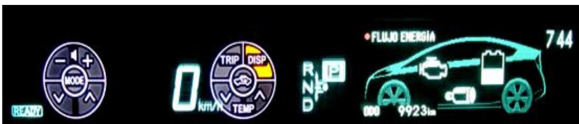
Figura 37.2: Panel de instrumentos indicando flujo de energía, comandos del volante, posición de la palanca de transmisión y velocímetro.
