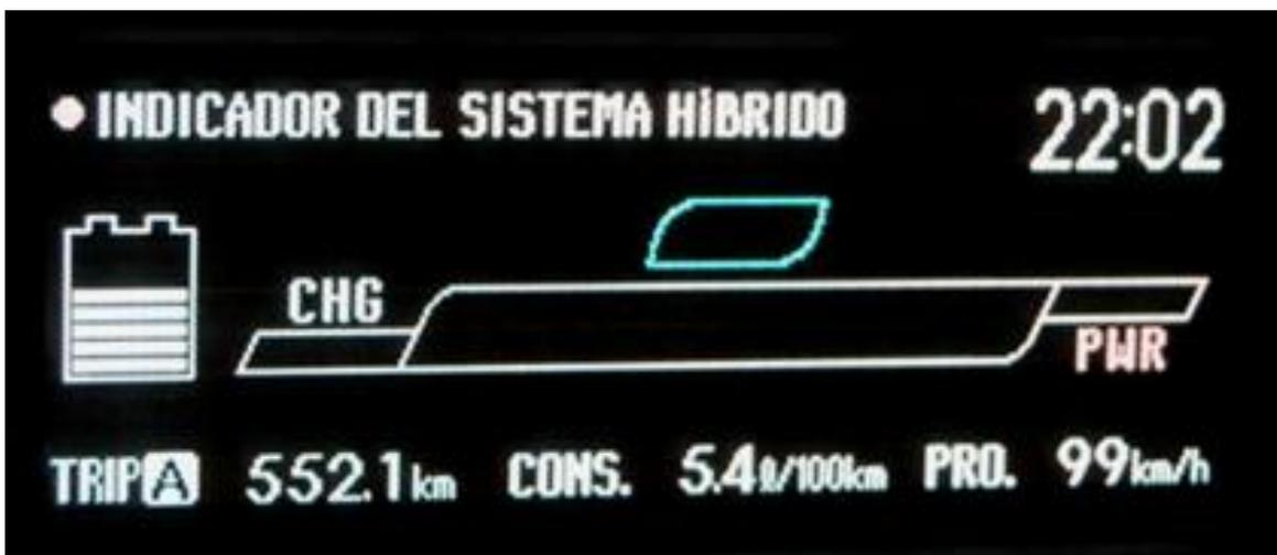
Figura 37.3: Indicador de carga y nivel de carga de la batería, hora, odómetro en función "trip A".
