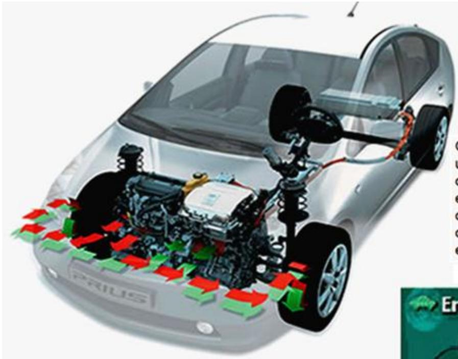
Conducción normal.- cuando alcanza una velocidad constante, la fuerza que da el motor térmico bien se divide entre el generador y el motor eléctrico. La corriente que da el generador en este caso puede ir a la batería o al motor eléctrico
