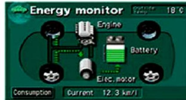
Figura 16.4: Flujo de fuerza y gráfica del panel de instrumentos, DESACELERACION.
