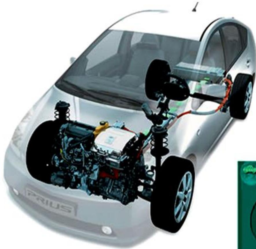
Parada.- cuando el coche queda totalmente detenido, el motor térmico se para, solo se pone en marcha si es que la batería necesita carga
