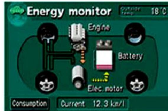
Figura 16.5: Flujo de fuerza y gráfica del panel de instrumentos. PARADA.
