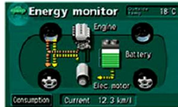
Figura 16.3: Flujo de fuerza y gráfica del panel de instrumentos. ACELERACION.
