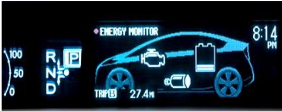
Figura 38: Indicador de que motor o motores están en uso y nivel de carga de la batería.
