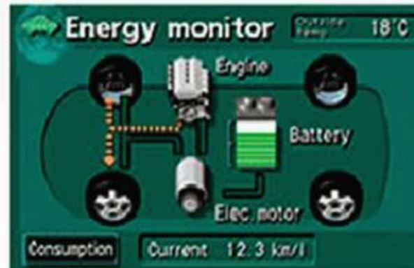
Figura 16.2: Flujo de fuerza y gráfica del panel de instrumentos. CONDUCCIÓN NORMAL.
