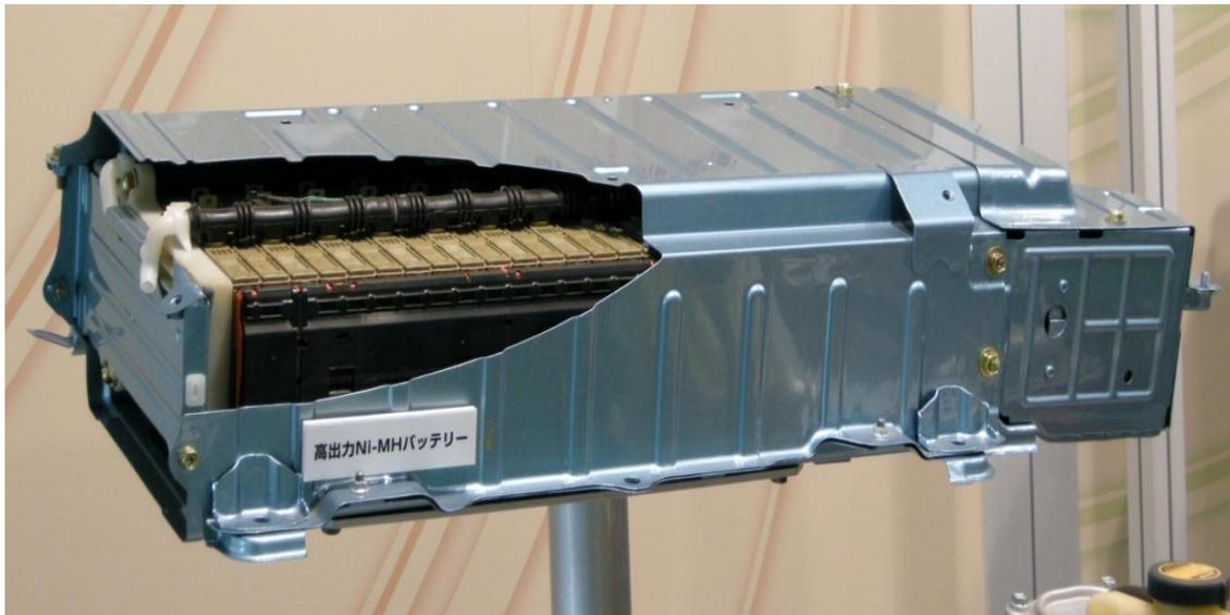
Figura 23: Batería seccionada del TOYOTA PRIUS.
