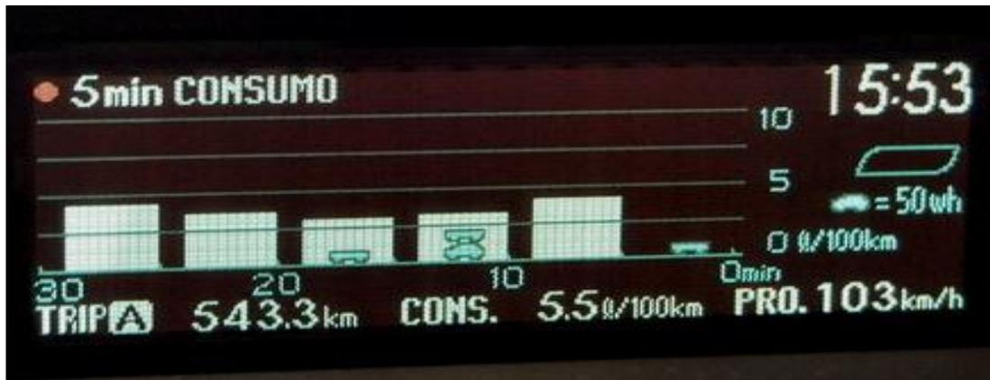
Figura 39: Panel de instrumentos indicando los promedios de consumo de combustible en lapsos de 10 minutos del TOYOTA PRIUS.
