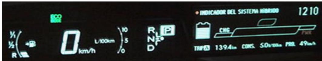
Figura 37: Panel de instrumentos, indicando área de carga, velocidad, posición de la palanca de mando de transmisión, nivel de combustible, modo de conducción.
