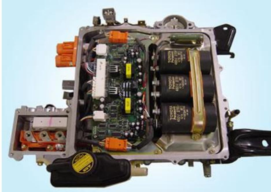
*Figura 29.1: Fotografía interna del inversor del TOYOTA PRIUS.*
