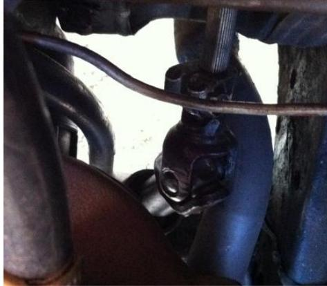
Figura 3. 34 Junta cardánica de unión entre columna y piñón
