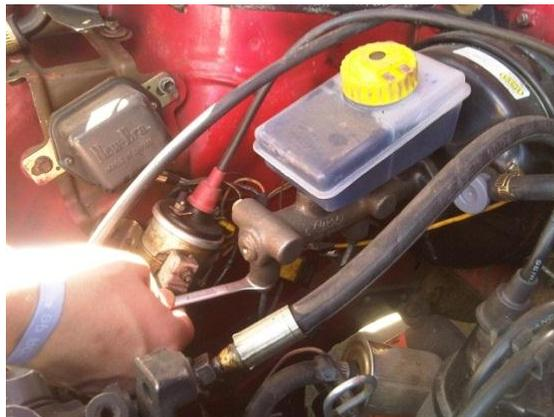
Figura 3. 85 Apriete de los racores de la bomba de frenos
