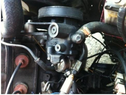
Figura 3. 44 Conexiones de la bomba hidráulica.
