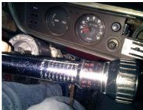
Figura 4. 23 Medición del esfuerzo en el volante de dirección.
