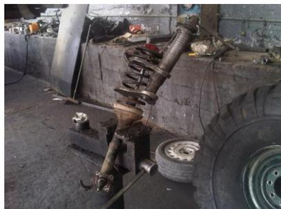
Figura 3. 65 Disposición del tren delantero para la extracción del muelle.
