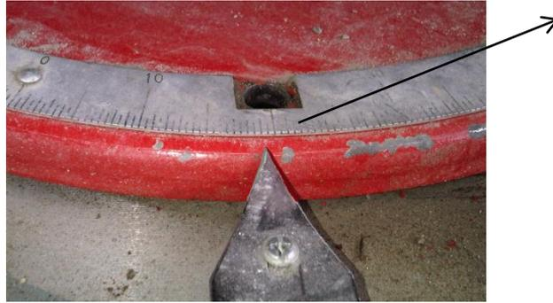
Figura 4. 26 Ángulo que describen las ruedas directrices en función del giro del volant
