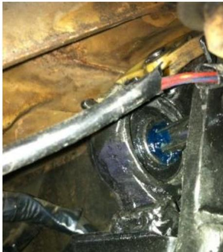
Figura 3. 81 Apoyo en el extremo del varillaje.
