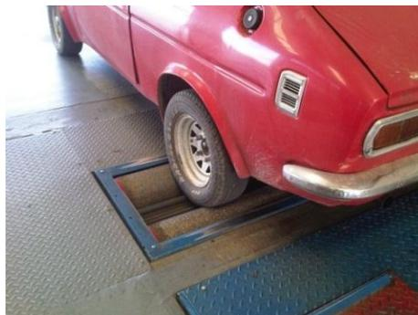
Figura 4. 10 Posicionamiento del eje trasero en los rodillos.
