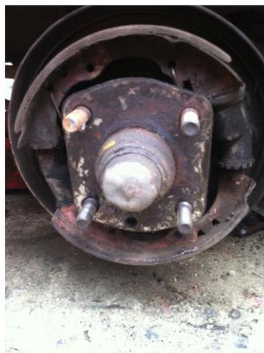
Figura 3. 50 Sistema de freno de tambor tipo dúplex del Toyota 1000.
