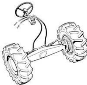
Figura 1. 23 Disposición de la dirección hidrostática
