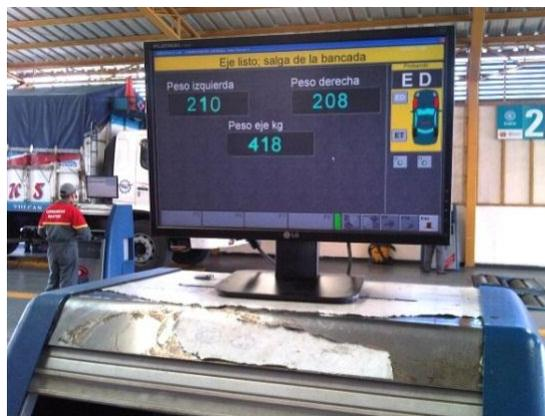
Figura 4. 12 Medición de los pesos del eje posterior.
