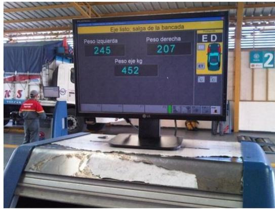
Figura 4. 11 Medición de los pesos del eje delantero.
