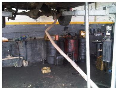
Figura 3. 23 Desmontaje del tubo de escape.
