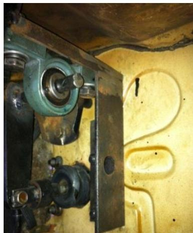
Figura 3. 79 Montaje del perfil con su respectivo rodamiento
