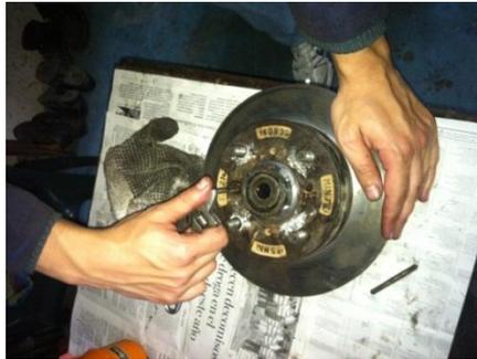
Figura 3. 74 Sujeción disco – manzana
