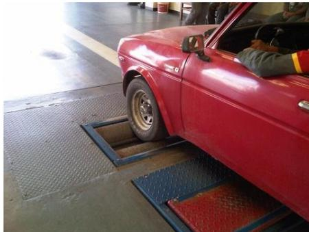
Figura 4. 9 Posicionamiento del eje delantero en los rodillos.
