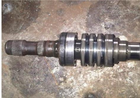
Figura 3. 7 Válvula de control.
