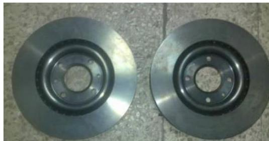
Figura 2. 34 Disco ventilado Chevrolet Steem.
