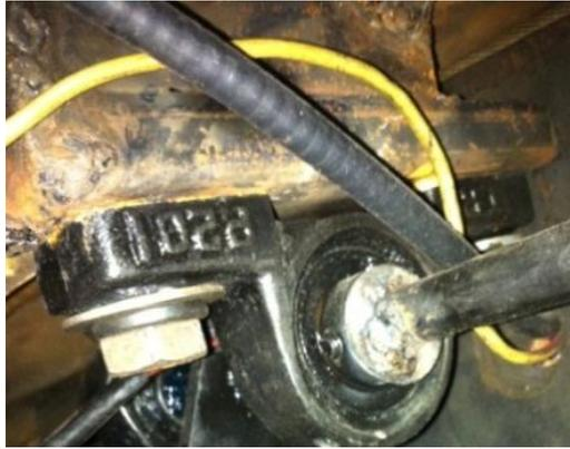
Figura 3. 80 Rodamiento empernado a la carrocería.
