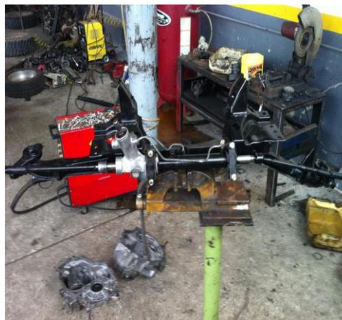
Figura 3. 30 Conjunto puente – caja de dirección.
