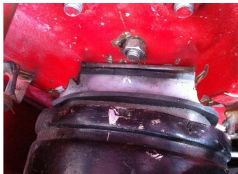
Figura 3. 77 Montaje del soporte de aluminio con sus respectivos empaques..
