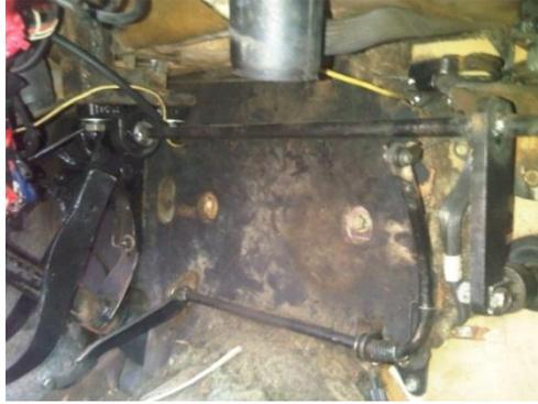
Figura 3. 84 Montaje del sistema de accionamiento de frenos.
