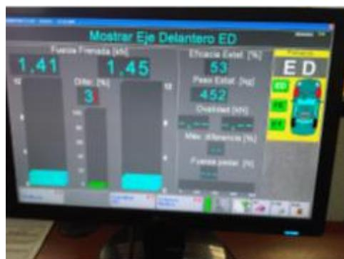
Figura 4. 14 Medición de la fuerza de frenada y eficacia - eje delantero.
