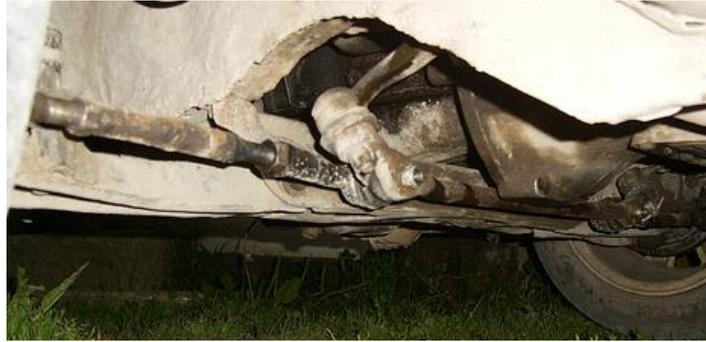
Figura 3. 1 Sistema de dirección de Toyota 1000 año 1977.
