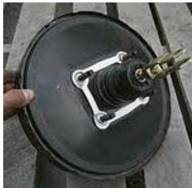
Figura 3. 55 Servo freno del vehículo Chevrolet San Remo.
