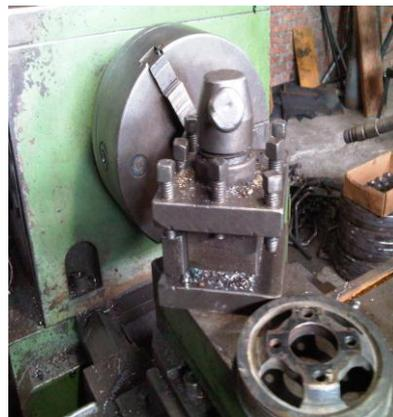
Figura 3. 37 Maquina utilizada para el desbaste (TORNO).
