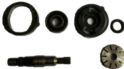
Figura 2. 24 Eje de una bomba de paletas con sus respectivas partes de acoplamiento.
