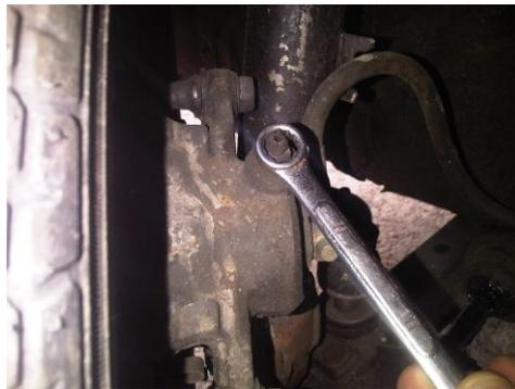
Figura 3. 87 Accionamiento de la tuerca de purgado.
