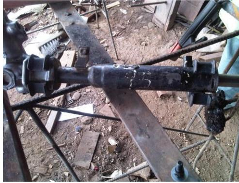
Figura 3. 29 Abrazaderas de caucho situadas a los extremos de la caja de dirección.
