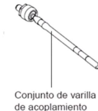
Figura 2. 10 Brazo de acoplamiento.
