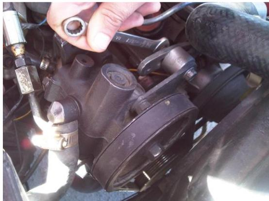
Figura 3. 43 Ajuste de la correa de transmisión de la bomba de dirección.
