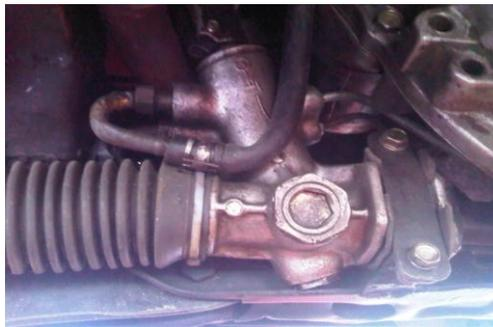
Figura 3. 45 Conexiones a la caja de dirección.
