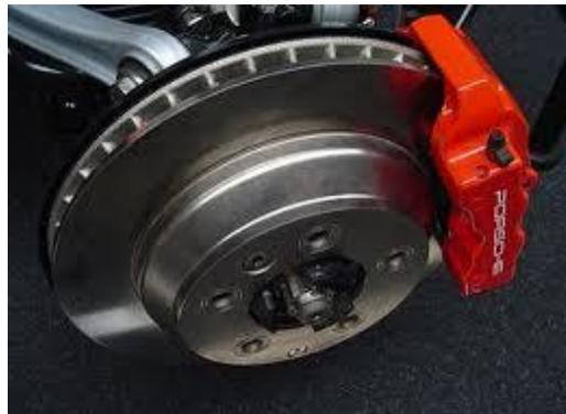
Figura 1. 46 Disco ventilado.
