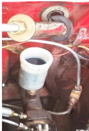
Figura 3. 49 Sistema de cañerías de tipo doble diagonal del Toyota 1000.
