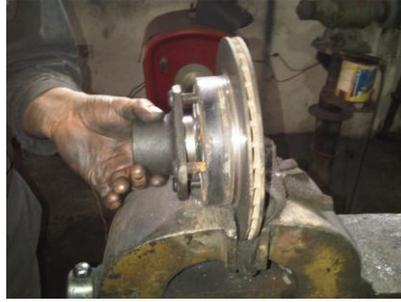
Figura 3. 73 Acople manzana – disco de frenos..
