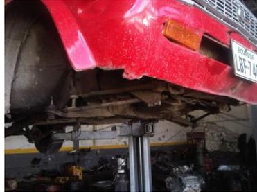
Figura 3. 21 Disposición para el desmontaje de la tirantería.
