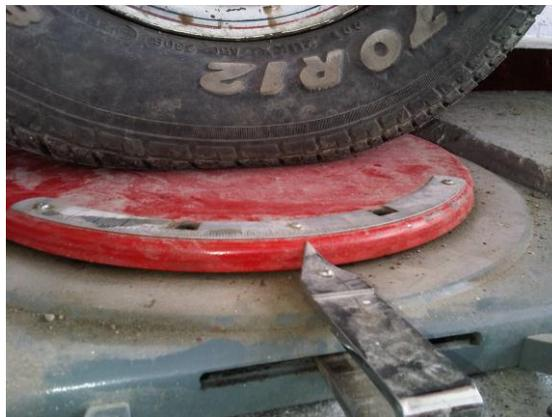
Figura 2. 5 Medición del ángulo de giro máximo.
