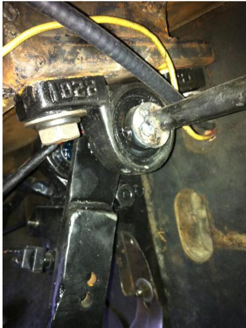
Figura 3. 83 Palanca de accionamiento unida al pedal.
