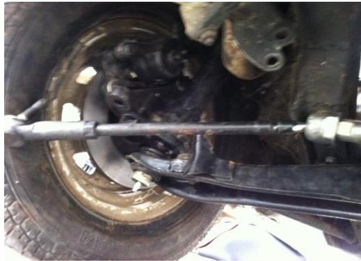
Figura 3. 32 Brazo de acoplamiento montado el conjunto puente-caja.
