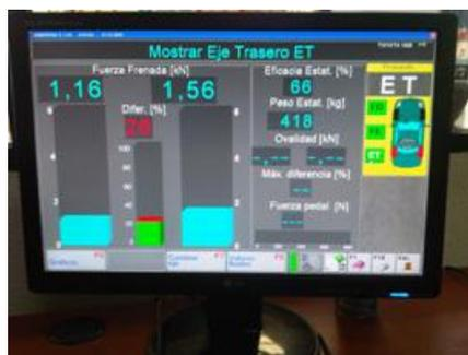
Figura 4. 17 Medición de la fuerza de frenada y eficacia eje trasero.
