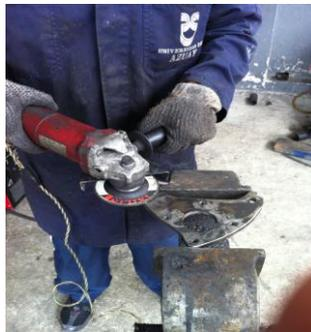
Figura 3. 72 Proceso de pulido de la pieza de sujeción.
