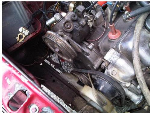
Figura 3. 41 Bomba alineada con la polea que transmite el movimiento.
