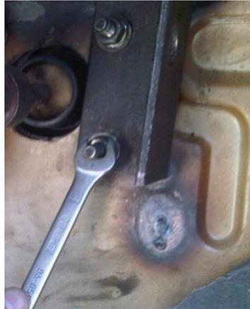
Figura 3. 78 Fijación del servo freno al chasis.
