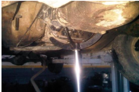
Figura 3. 25 Desmontaje del puente con un gato hidráulico.
