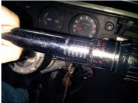
Figura 4. 22 Medición del esfuerzo en el volante de dirección
