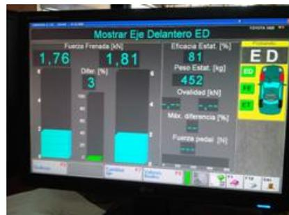
Figura 4. 16 Medición de la fuerza de frenada y eficacia eje delantero
