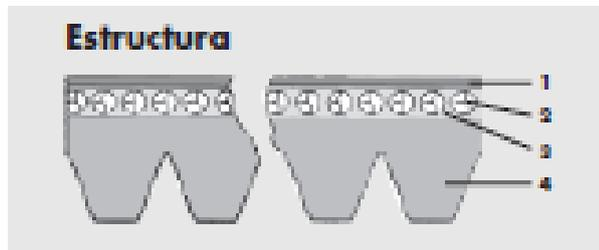
Figura 3. 17 Estructura de correas estriadas.
