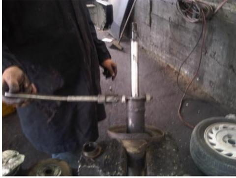
Figura 3. 66 Desmontaje del amortiguador situado en la botella de la mangueta.
