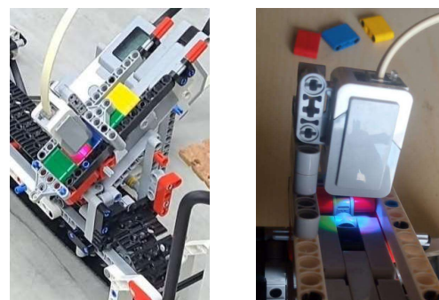
Fig. 46. Sensor colocado en una posición adecuada para el reconocimiento del color.
