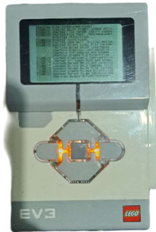
Fig. 28. Cargando firmware en brick EV3.
